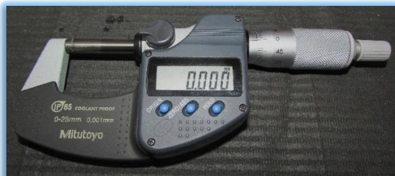
Imagen 12. Micrómetro digital Mitutoyo: mediciones 0.001mm – 25mm (1000 \mu m = 1mm)
