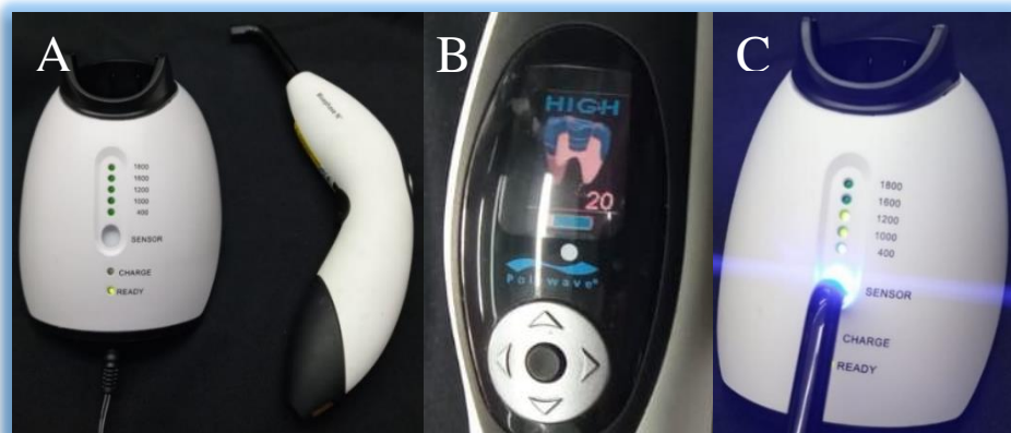
Imagen 6. Medición de la Intensidad de luz; A lámpara Led Bluephase N (Ivoclar Vivadent) y radiómetro de la lámpara Led F(Woodpecker); B programa HIGH POWER; C medición de la intensidad de luz.
