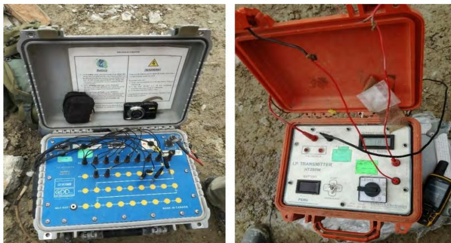
*Nota.* Se aprecia el equipo RX GDD 10 canales (der.) y el transmisor
