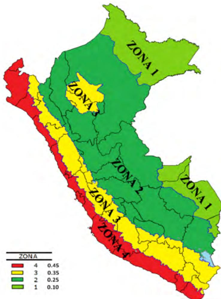
*Nota.* Zonificación sísmica del territorio nacional y coeficientes de aceleración sísmica. Tomado de *Norma E.030 Diseño Sismoresistente* (p. 12), por MVCS, 2020 Edición Digital SENSICO.
