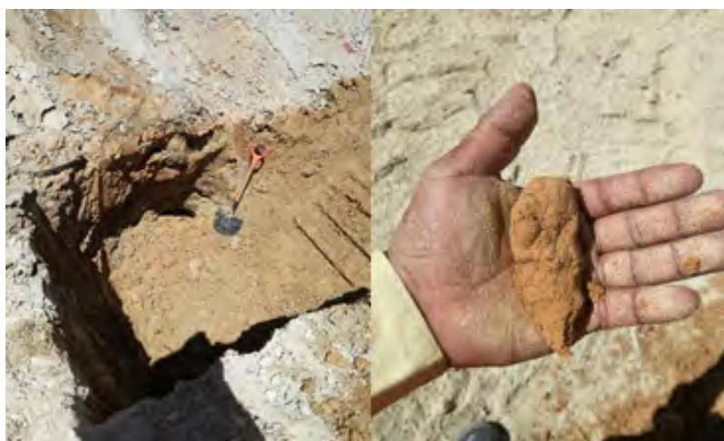
Se presenta húmeda, su consolidación ha hecho que se le haya excavado notándose las marcas de la maquinaria pesada empleada, la cual formo pendientes fuertes y casi subverticales y en los extremos de los taludes se contiene bolones (< 0,3 m) de roca angulosa a subangulosa.
