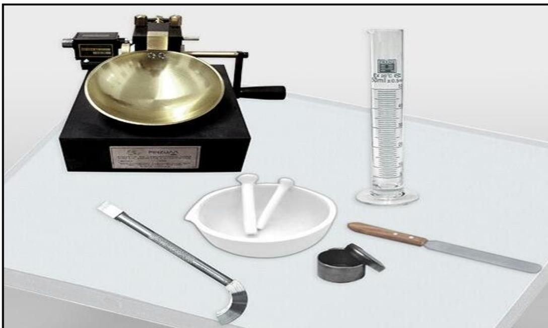
*Nota.* La figura muestra el equipo para poder realizar el ensayo de límite líquido. Tomado de: *Conjunto para determinar el límite líquido, Geo Perú ingenieros* (<http://www.geoperuingenieros.com/laboratorio-de-suelos-concreto-asfalto-maquinas.html>).
