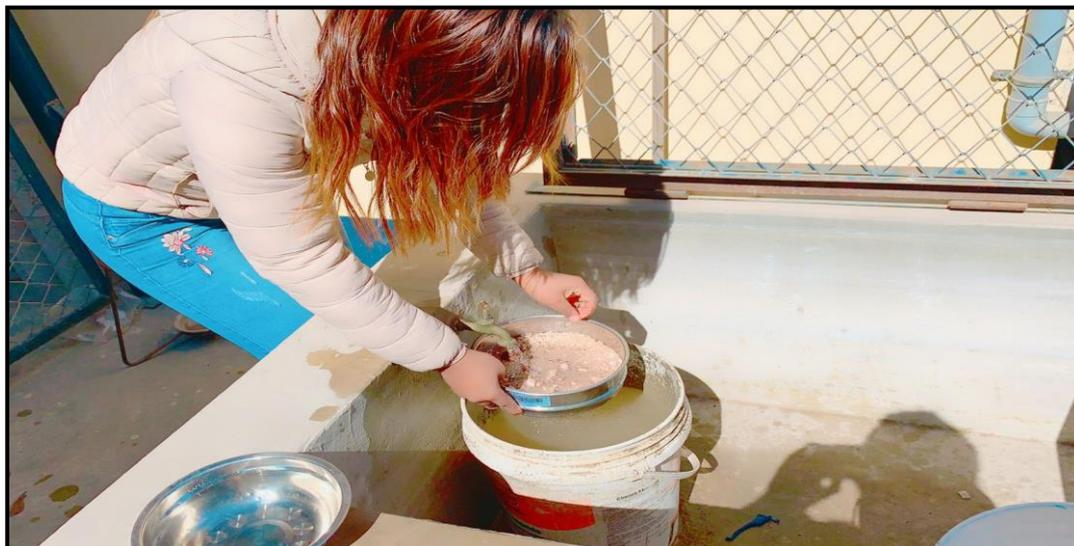
*Nota.* La figura presenta el lavado de muestra de una de las calicatas que serán posteriormente secadas al horno y finalmente tamizadas.
