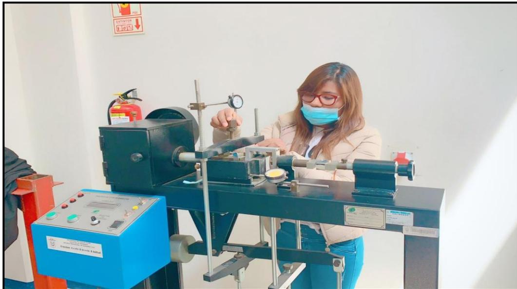
*Nota.* En la imagen se observa la colocación de la muestra en el equipo de corte directo
