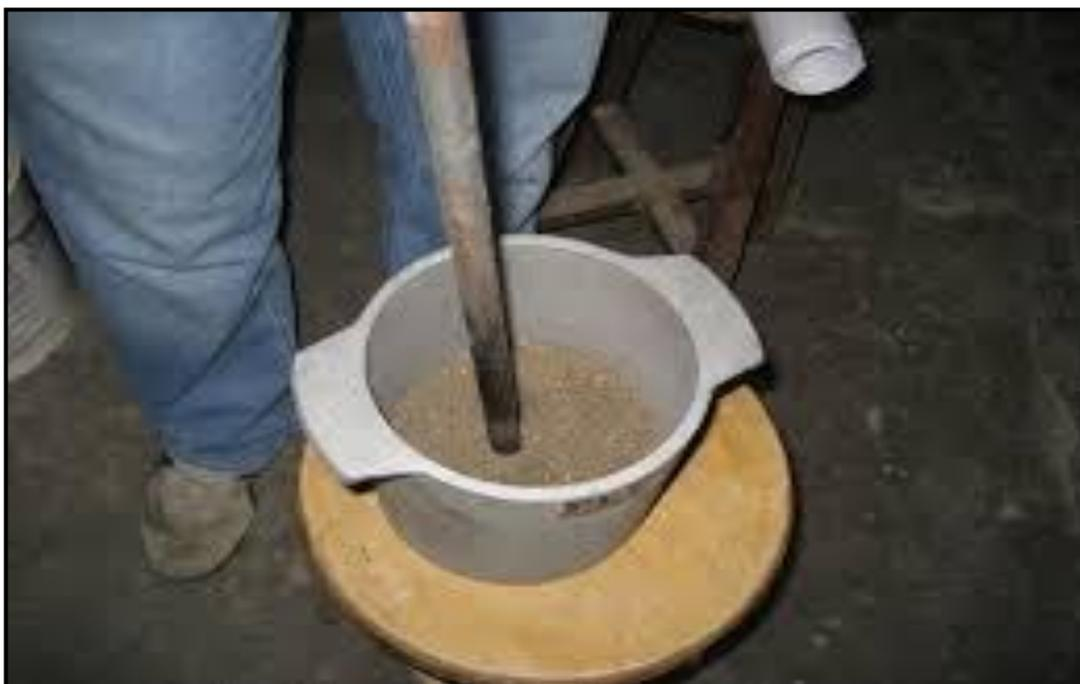
*Nota.* La figura presenta el proceso de compactación de la muestra mediante el varillado para poder determinar posteriormente la densidad máxima de esta. Tomado de: *Varillado a n/3 de la capacidad de los moldes*, de Laboratorio de Materiales de construcción, Universidad Centro Americana José Simón Cañas, (<https://www.uca.edu.sv/mecanica-estructural/materias/materialesCostruccion/guiasLab/ensayoAgregados/PESOS%20UNITARIOS%20Y%20%25%20VACIOS.pdf>)
