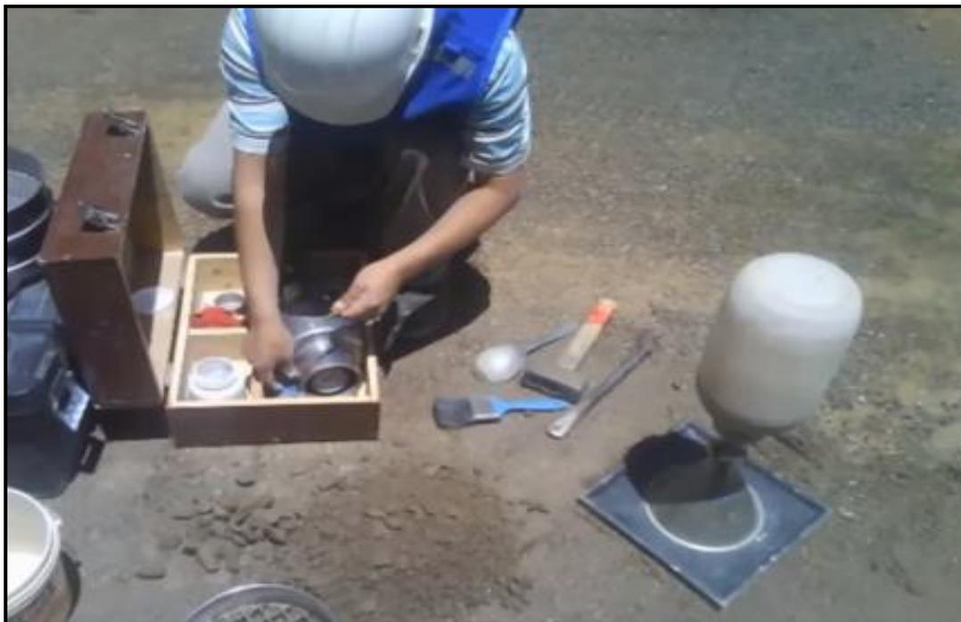
*Nota.* Adaptado de *Determinación de la densidad seca y la humedad de un suelo compactado*, IngenieríaReal.com(<https://ingenieriareal.com/como-realizar-ensayo-densidad-en-el-sitio-con-el-cono-de-arena/>).
