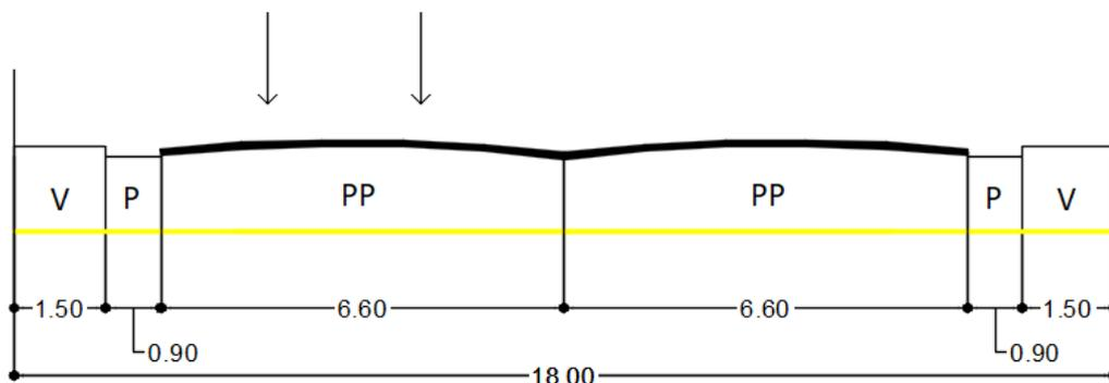
*Nota.* En la imagen se observa la nueva sección vial del acceso N°3 donde la longitud de acera es 1,50 m, se eliminan los estacionamientos, pero se tiene un espacio de 0,90 m para poder utilizarlo como paradero, cuenta con una calzada de 6,60 m con un ancho de carril de 3,30 m.
