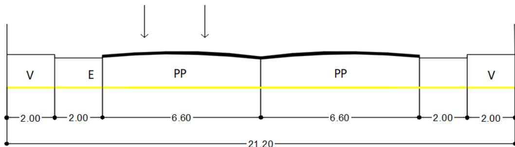
*Nota.* En la imagen se observa la nueva sección vial del acceso N°2 donde la longitud de acera es 2,0 m, se cuenta con un estacionamiento de 2,00 m y una calzada de 6,60 m con un ancho de 3,30 m por cada carril.
