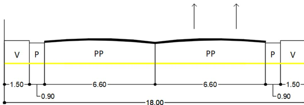
*Nota.* En la imagen se observa la nueva sección vial del acceso N°1 donde la longitud de acera es 1,50 m, se eliminan los estacionamientos, pero se tiene un espacio de 0,90 m para poder utilizarlo como paradero, cuenta con una calzada de 6,60 m con un ancho de carril de 3,30 m.
