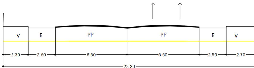
*Nota.* En la imagen se observa la nueva sección vial del acceso N°4 donde la longitud de acera es 2,70m, se cuenta con un estacionamiento de 2,50 m, una calzada de 6,60 m que tiene 2 carriles de 3,30 m cada uno.
