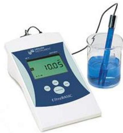
Fig. 04 Potenciómetro
