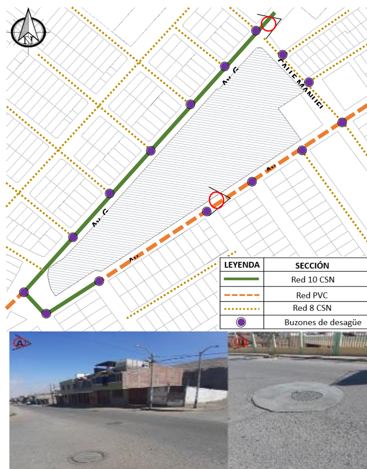
Figura 80. Desagüe y/o Alcantarillado
