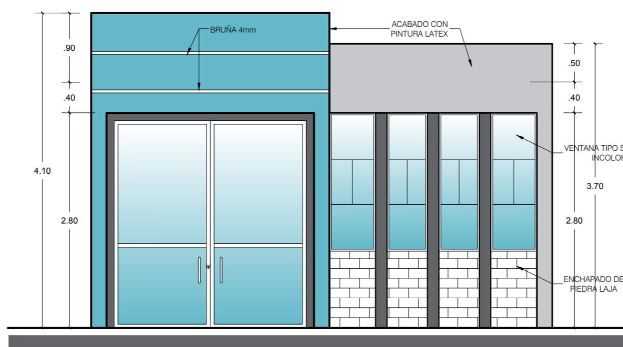
ELEVACION FRONTAL MÓDULO 4 / VIVIENDA DE OFICIALES ESC.1/50
