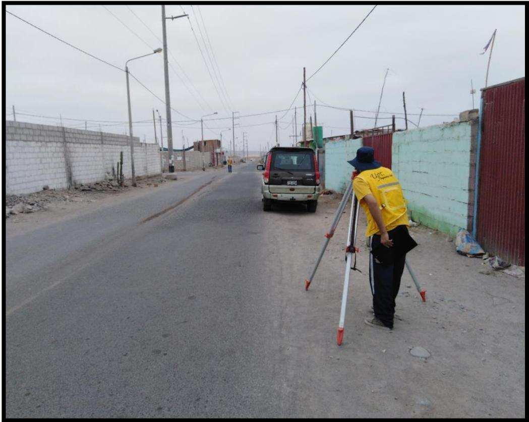
**Fotografía 01: Medición de cotas tapa con nivel y mira.**
