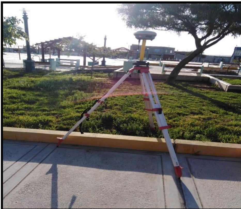
**Fotografía 16: Levantamiento topográfico con GPS Diferencial.**
