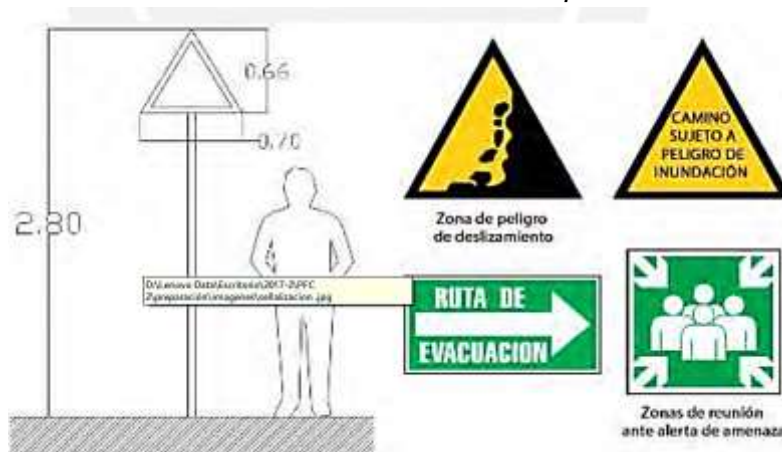
Figura 89. Detalles de Señalización a Colocar
