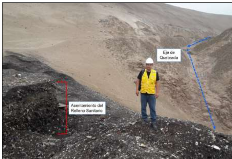
Figura 28. Asentamiento del Relleno Sanitario - Quebrada del Diablo
