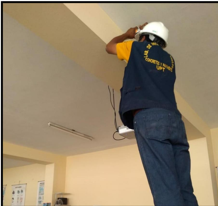
**Ensayo de Esclerómetro en vigas**
