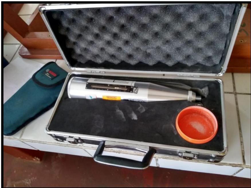
**Equipo para el ensayo (ESCLEROMETRO)**
