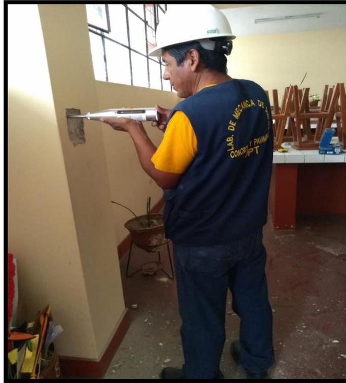
**Ensayo de Esclerómetro en columnas**
