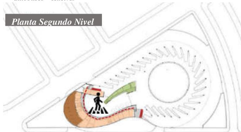
Figura 18. Zonificación y circulación del segundo nivel en la estación de autobuses – Huelva.
