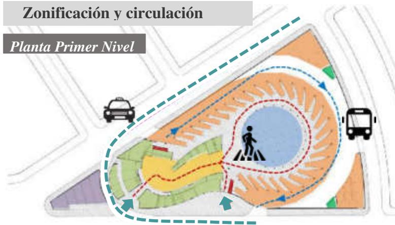
Figura 17. Zonificación y circulación del primer nivel en la estación de autobuses – Huelva.
