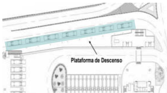
Figura 214. Esquema general Plataforma de descenso para autobuses interprovinciales
