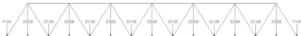
Figura 46 Carga muerta en los nudos del reticulado
