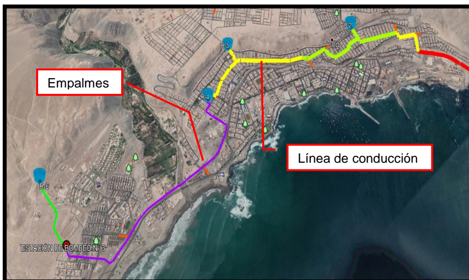
Figura N° 2: Empalmes en redes de conducción de agua potable (fuente propia)
