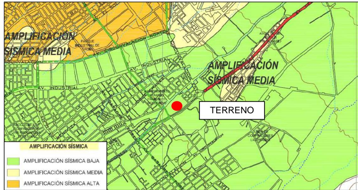
Figura 19. Amplificación sísmica local.
