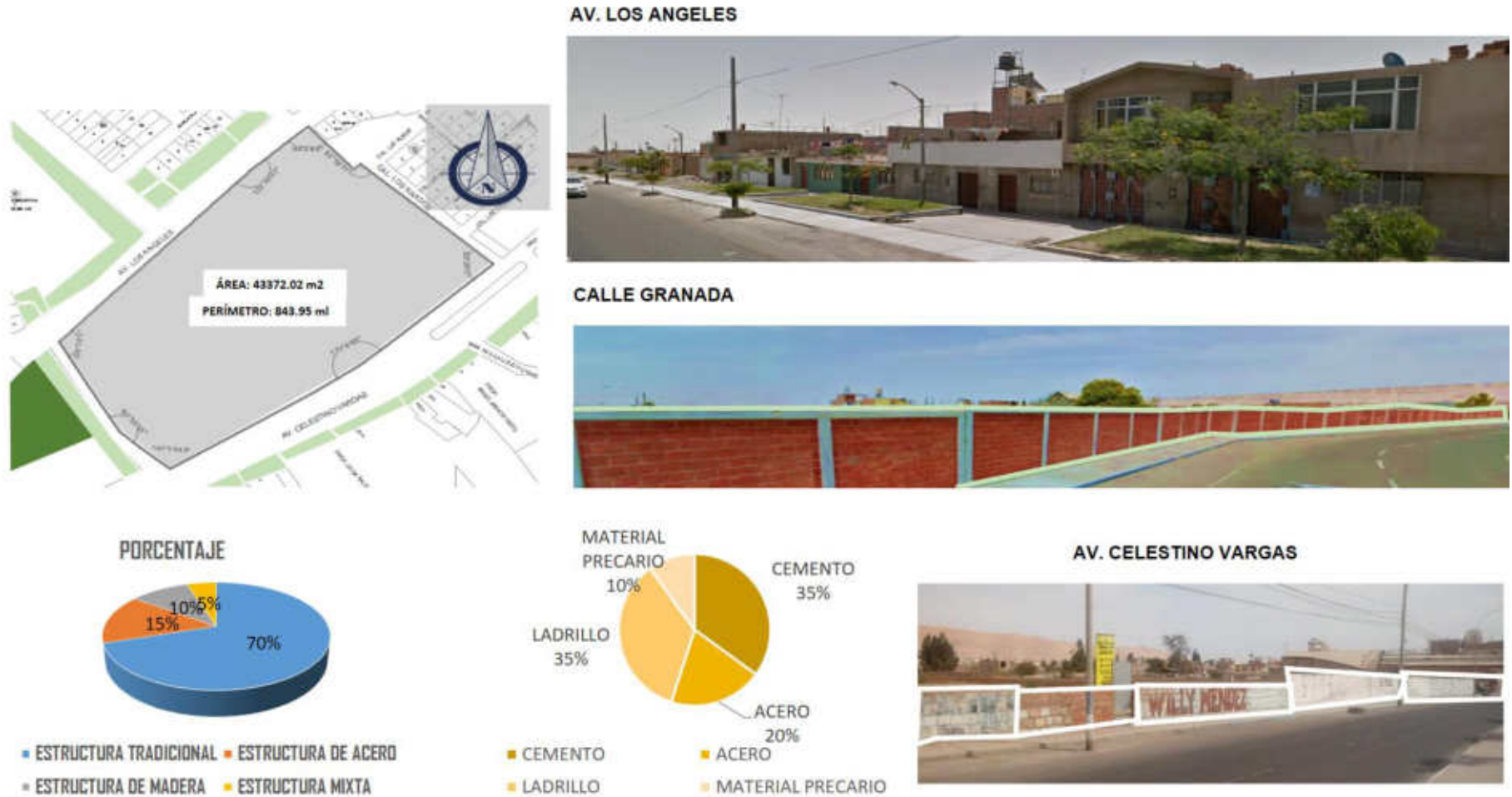
Figura 82 Material de construcción predominante
