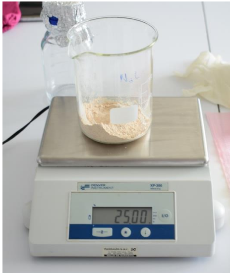
Figura N° 03: Pesando el polvo pulverizado de la Tara
