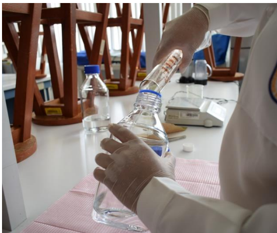
Figura N° 05: Mezclando el polvo y agua destilada
