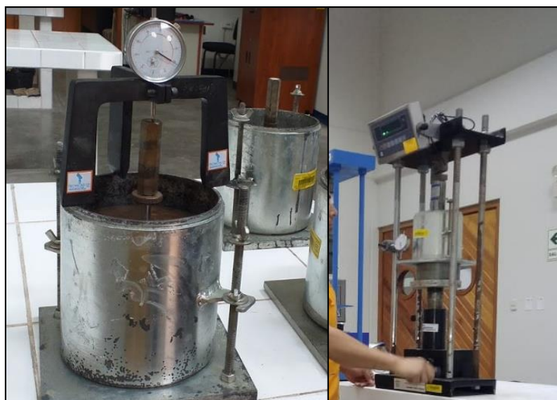
Figura 23. Ensayo de CBR. Fuente Elaboración Propia
