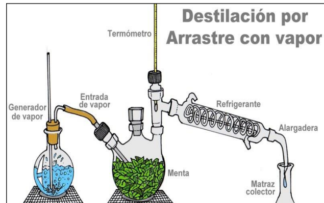
Figura 7: Destilación por arrastre Fuente: Domínguez, X. A., 1990
