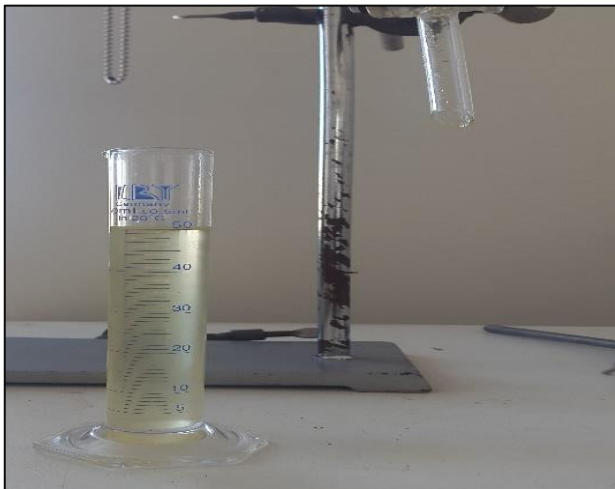
Figura 13. Decantación de aceite de Mejorana en Seco Fuente: Elaboración propia.
