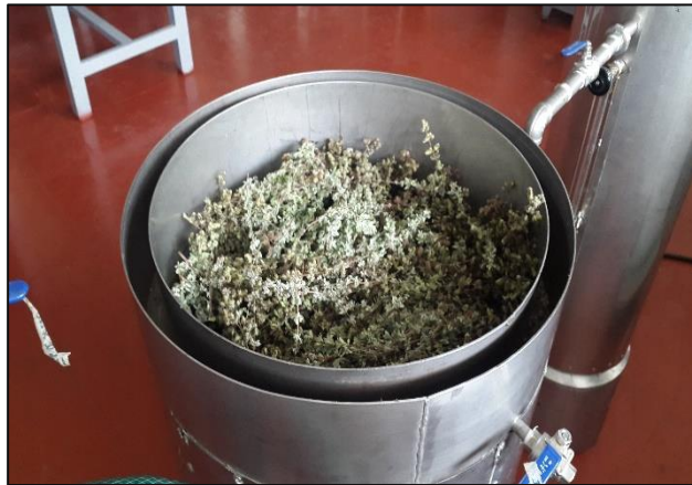
Figura 8. Colocación de hojas de Mejorana en Fresco en la destiladora Fuente: Elaboración propia
