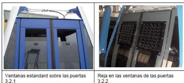
Figura 17. Cabinas de teleférico DIAMOND.
