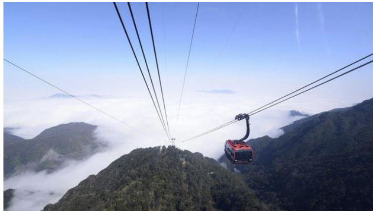
Figura 20. Sistema de tres cables.
