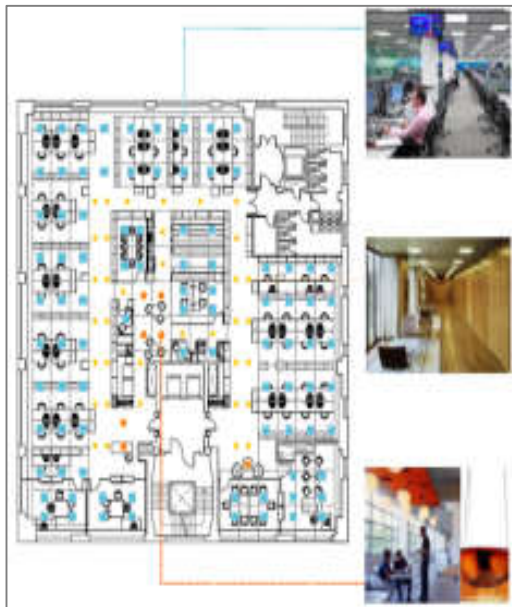
Figura 38: Luminarias de oficinas
