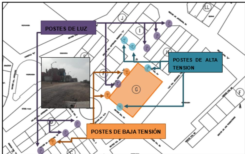
Figura 53. Distribución de postes de luz, postes de alta y baja tensión
