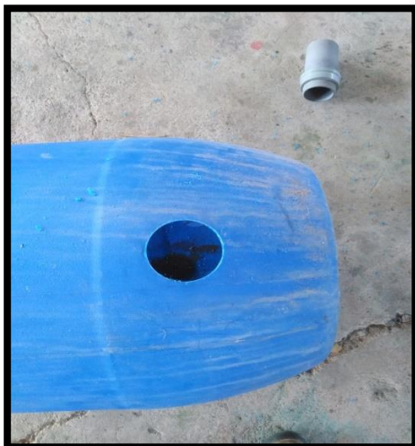
Fotografía N° 01: Agujero en el pie del bidón hecho por broca circular Fuente: elaboración propia
