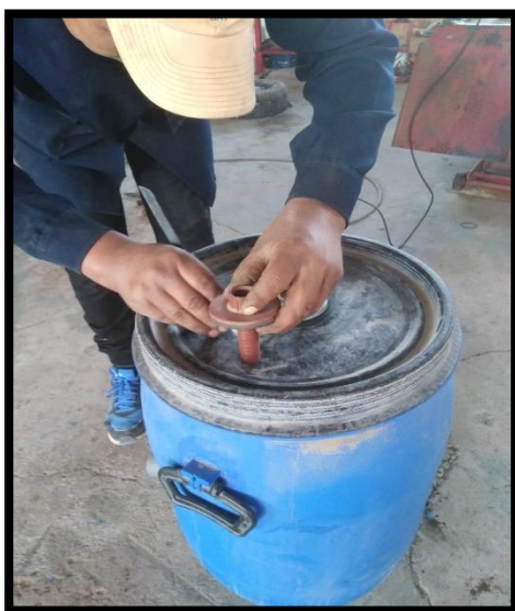
Fotografía N° 03: Implementación de a tuerca con la contratuerca Fuente: elaboración propia
