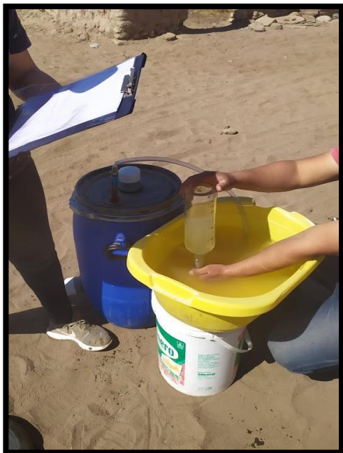
Fotografía N°08: método de medición por prueba de botella invertida
