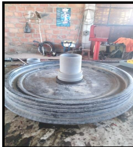
Fotografía N° 02: agujero en la tapa del bidón, para ingreso de la mezcla Fuente: elaboración propia
