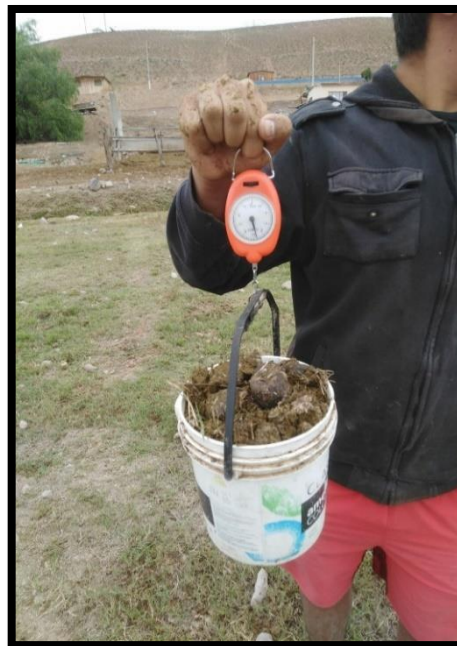
Fotografía N° 07: Pesaje para encontrar la densidad de los estiércoles y silo de maíz Fuente: elaboración propia
