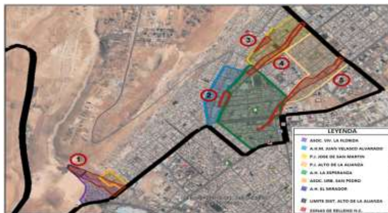
FIGURA N° 13. Zonas con presencia de Rellenos no controlado en el Dist. Alto de la Alianza Fuente: Google Earth
