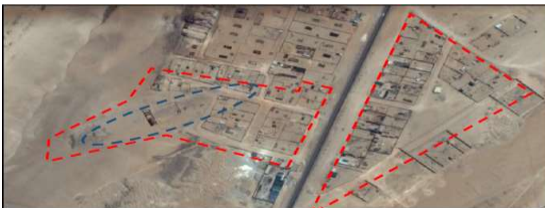
FIGURA N° 75 Imagen satelital del año 2014 de la Asoc. De Viv. Alto Santa Cruz, lotización sobre relleno sanitario
