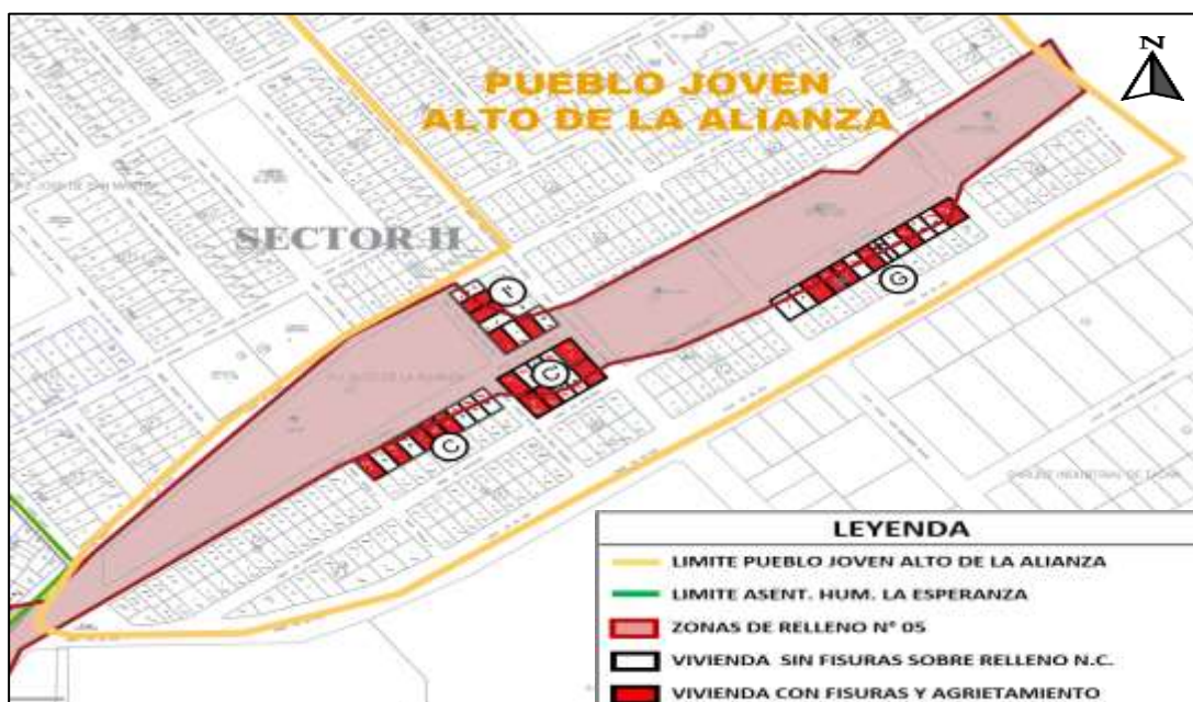
FIGURA N° 98. Plano catastral de ubicación de viviendas con fisuras en el P.J. Alto de la Alianza
