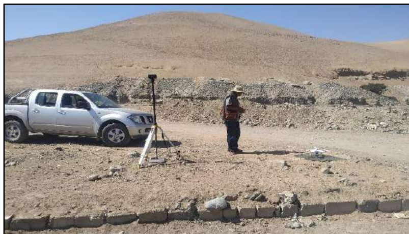
Figura 4: Estacionamiento de la base del Drone margen izquierdo como se aprecia en la imagen.
