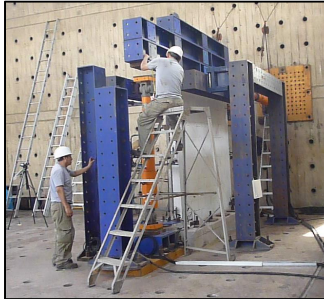
Fig. 5-6 Colocación de actuador hidráulico
