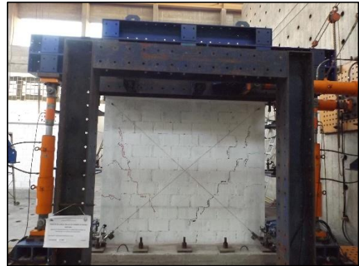
Foto 2. Grietas formadas a largo de la diagonal en la cara norte del muro a una distorsión 1/1100.
