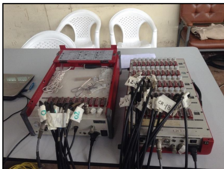
Fig. 5-11 Equipo de recepción de los 22 canales.
