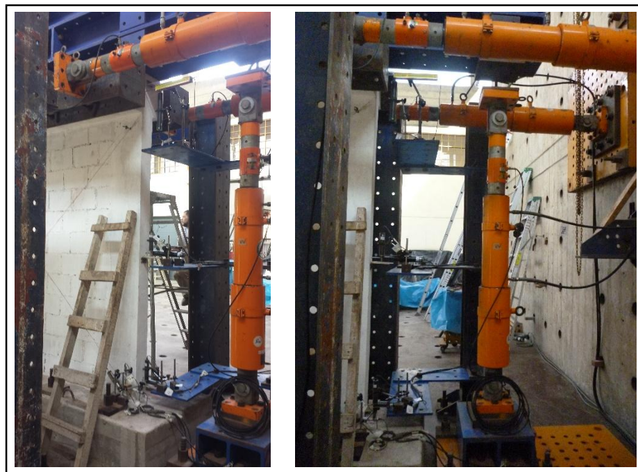
Fig. 5-7 Colocación de actuador hidráulico horizontal
