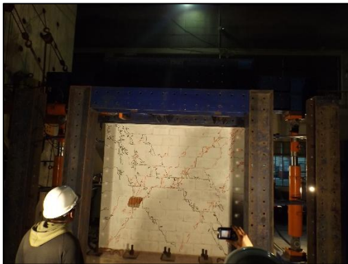
Foto 9. Acumulacion de grieta en la diagonal del muro y desprendimiento de pequeños pedazos de la albañilería, ara una distorsión de 1/300 .
