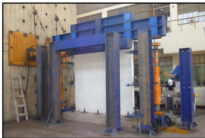
Fig. 5-5 . Muro anclado a la losa del laboratorio.
