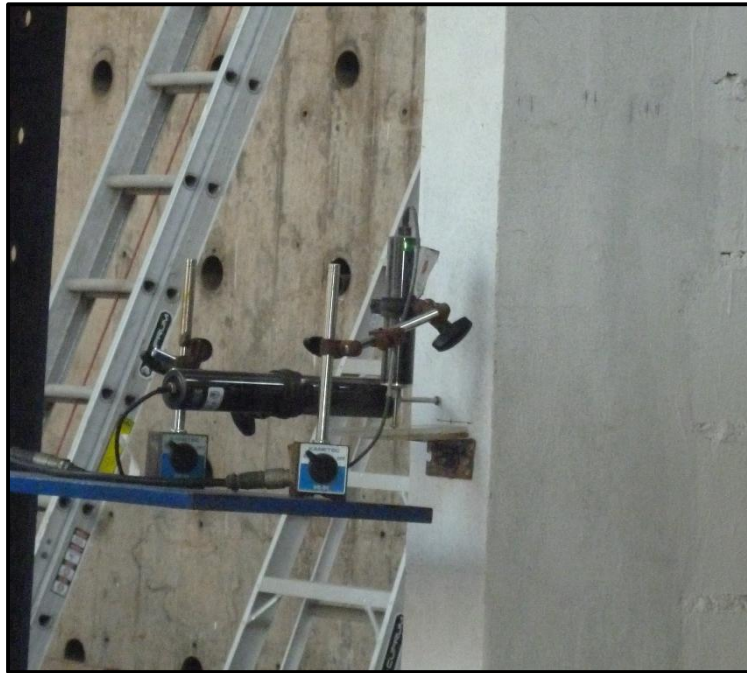
Fig. 5-10 Colocación de los LVDTs (Transformador diferencial de variación lineal) en la columna
