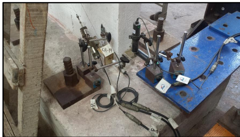
Fig. 5-9 Colocación de los LVDTs (Transformador diferencial de variación lineal) en la base.
