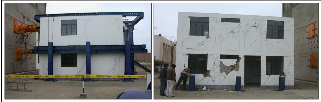
Fig. 2-22 Ensayo pseudo-dinámico en Perú
