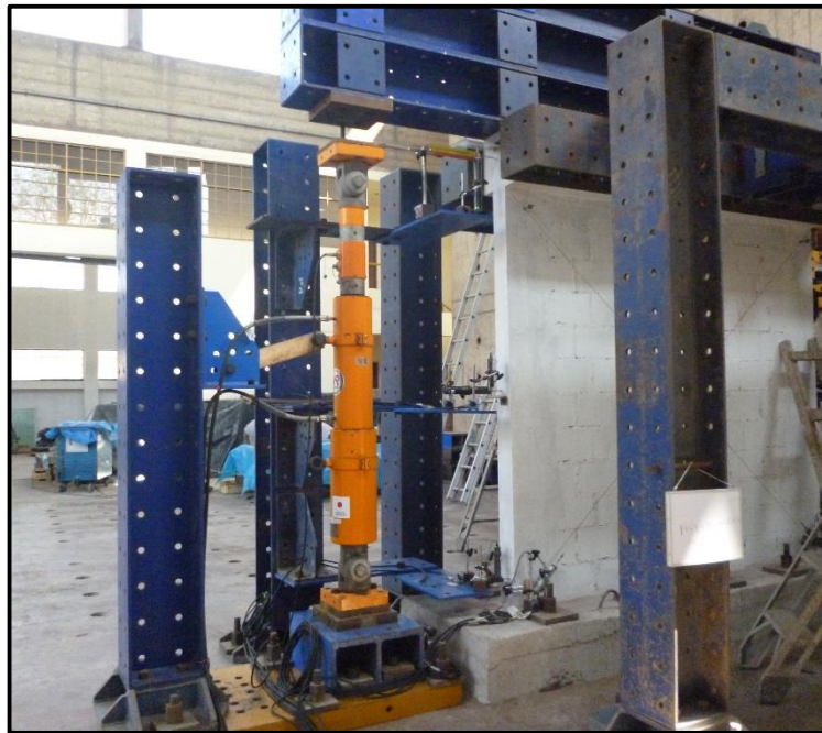
Fig. 5-8 Colocación de los LVDTs (Transformador diferencial de variación lineal)
