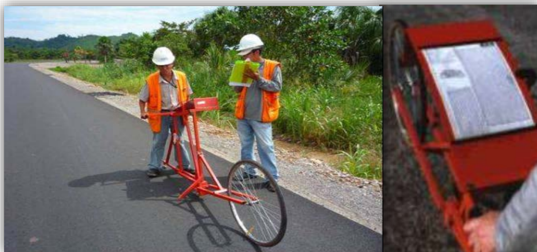
Figura N°07: Metodología para la determinación de la rugosidad, uso del Rugosímetro Merlin Fuente: Elaboración propia
