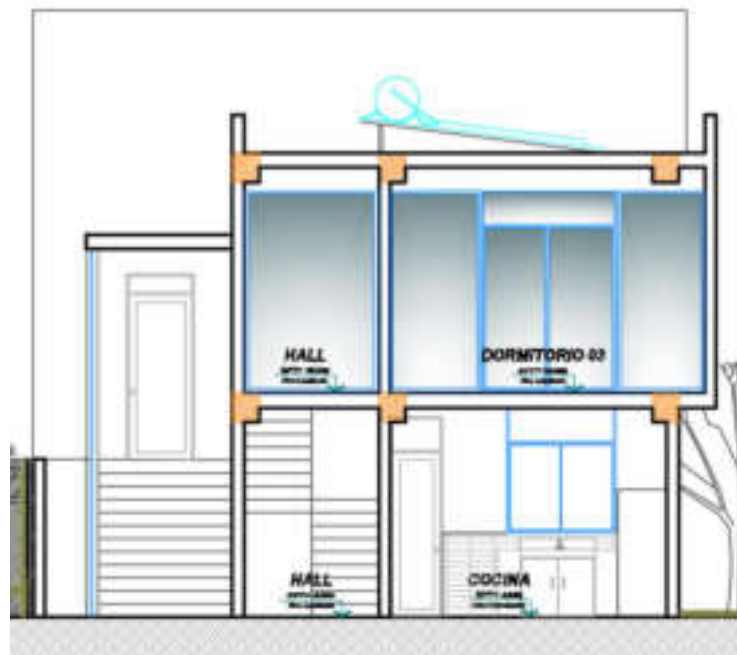
Figura 118: Panel solar en vivienda
