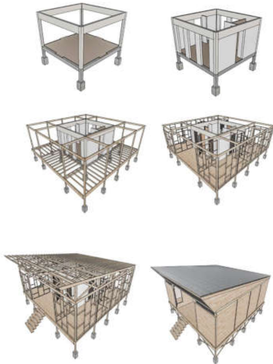
Figura 16: Proceso constructivo del módulo de vivienda
