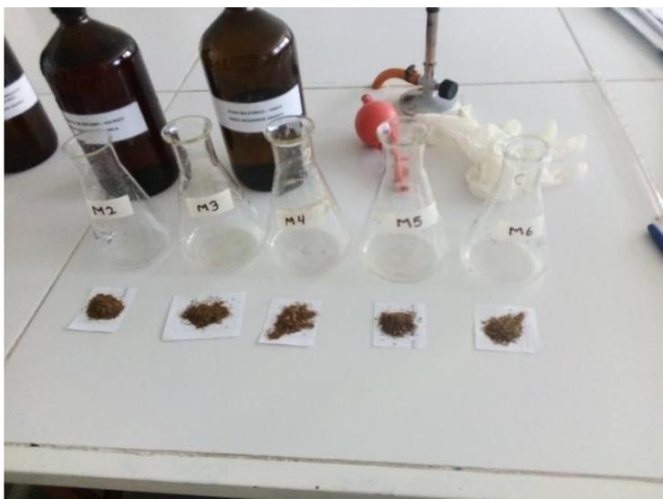
**Figura 28.** Preparación para la oxidación de la muestra con dicromato de potasio
