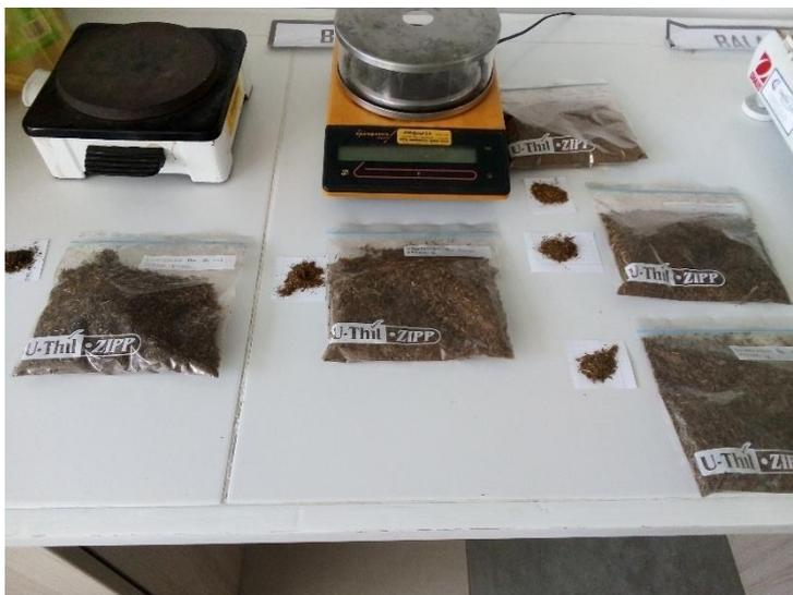
**Figura 27.** Pesaje de muestras secas para determinación de fracción de carbono por el método de Walkley y Black
