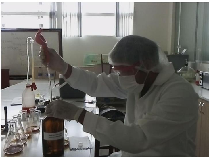
**Figura 29.** Oxidación de muestra con dicromato de potasio y ácido sulfúrico
