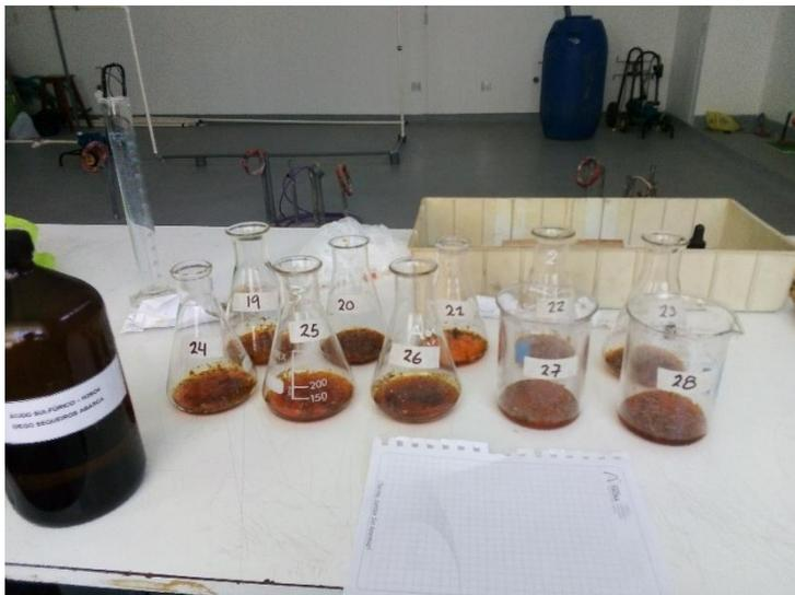
**Figura 30.** Preparación de agua destilada y se titulación con sulfato ferroso amoniacal
