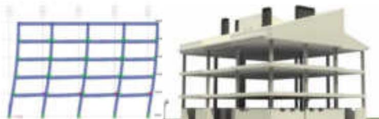
Figura 86 Sistema constructivo Aporticado
