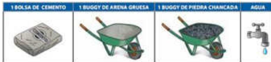
Figura 83 Proporción de concreto para  $f'c=175\text{kg/cm}^2$
