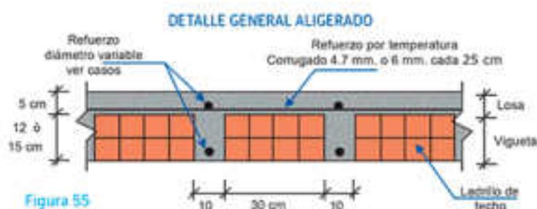
Figura 84 Losa Aligerada
