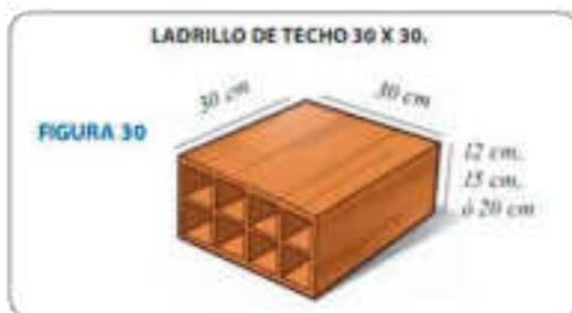
Figura 77 Ladrillo de techo .30 x .30 m
