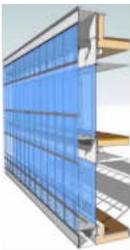
Figura 107 detalle de Muro Cortina
