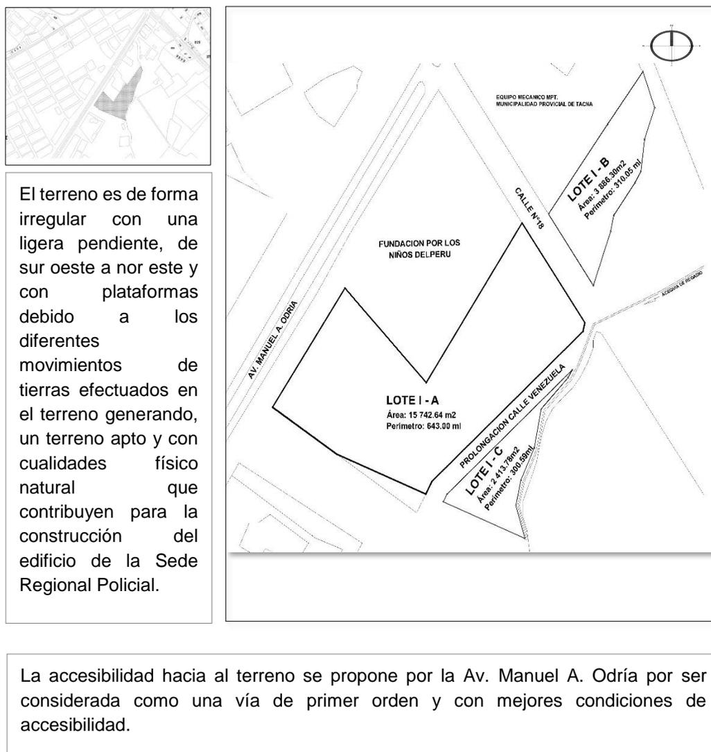
**Figura 47:** Condicionantes del sistema físico espacial: forma, topografía y accesibilidad
