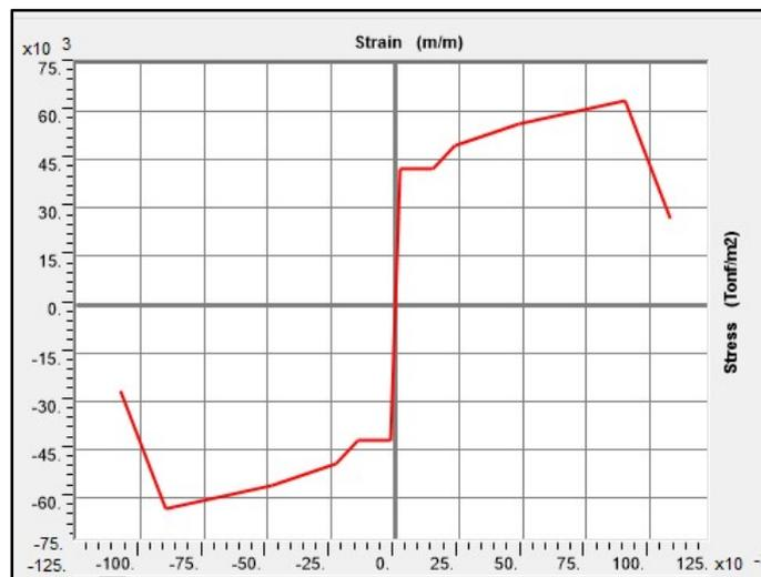
**Figura 50:** Curva de comportamiento del acero.
