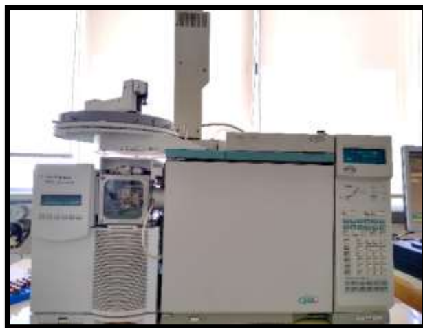
Figura 40. Cromatógrafo MSD – Mass Selective Detection.
