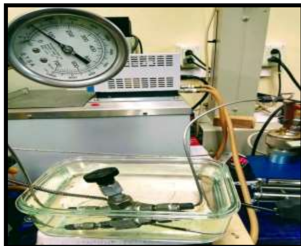
Figura 36. Válvula de expansión del CO 2 a temperatura óptima y manómetro.
