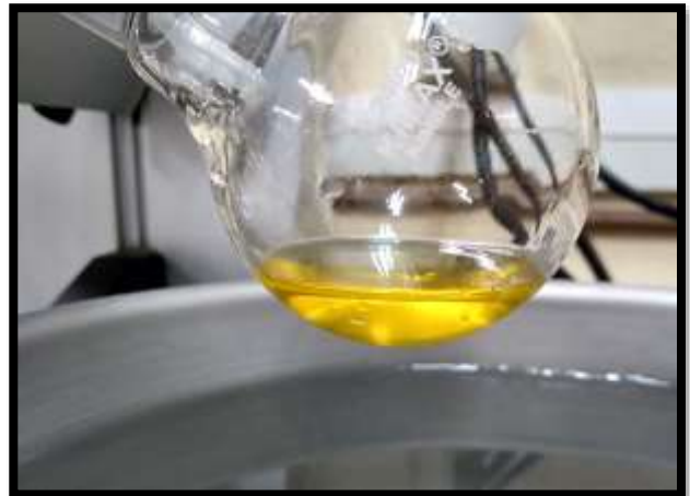
Figura 32. Aceite de semilla de granada obtenido por método Soxhlet.
