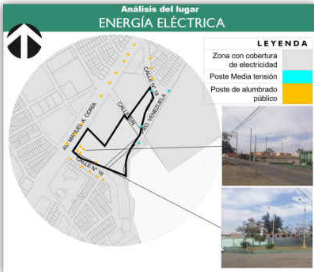
Figura 86 Análisis del lugar – energía eléctrica
