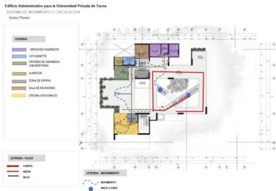
Figura 46: Sistema de movimiento y circulación – Sexta planta.
