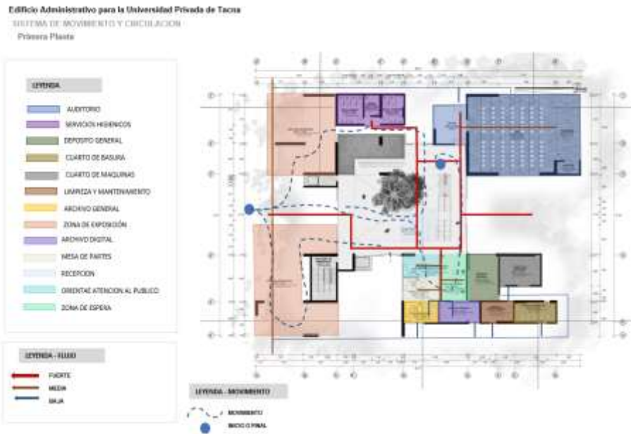
Figura 41: Sistema de movimiento y circulación – Primera planta.
