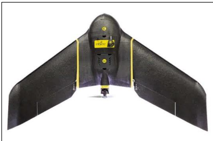
Figura.7: VANT de ala fija Ebee (Fuente: Sensefly)
