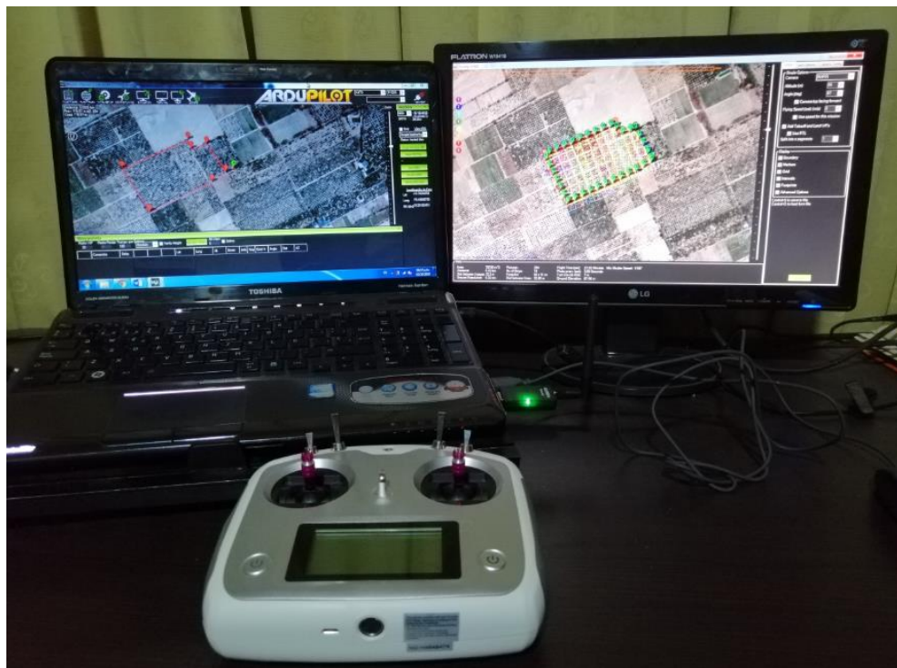
Figura.28: Estación de control y monitoreo (Fuente: Elaboración propia)
