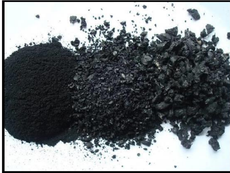
Figura. 4. Tamaños de las partículas de caucho reciclado triturado en el mercado. Caso práctico utilizado en esta investigación polvo de caucho (Fuente: Cauchoperu.com).
