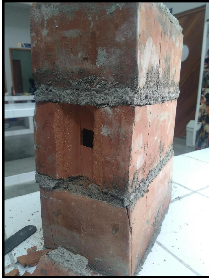
Figura 17. Falla en ensayo de compresión axial pilas de albañilería. Esta imagen refleja una falla no deseada, puesto que se tritura parte de la unidad Hércules I, en este caso, usando 30% de polvo de caucho modificado en el mortero. (Fuente: Propia).
