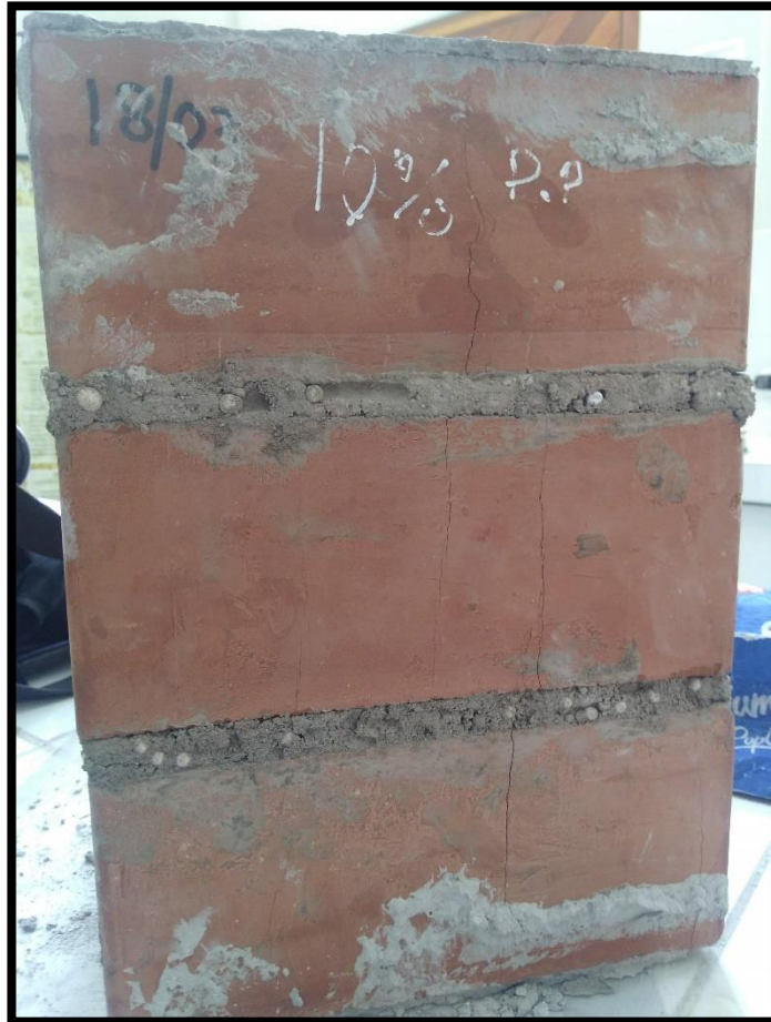
Figura 16. Falla en ensayo de compresión axial pilas de albañilería. Esta imagen refleja la falla por agrietamiento vertical, corta la unidad y el mortero en el caso de 10% de poliestireno expandido. (Fuente: Propia).
