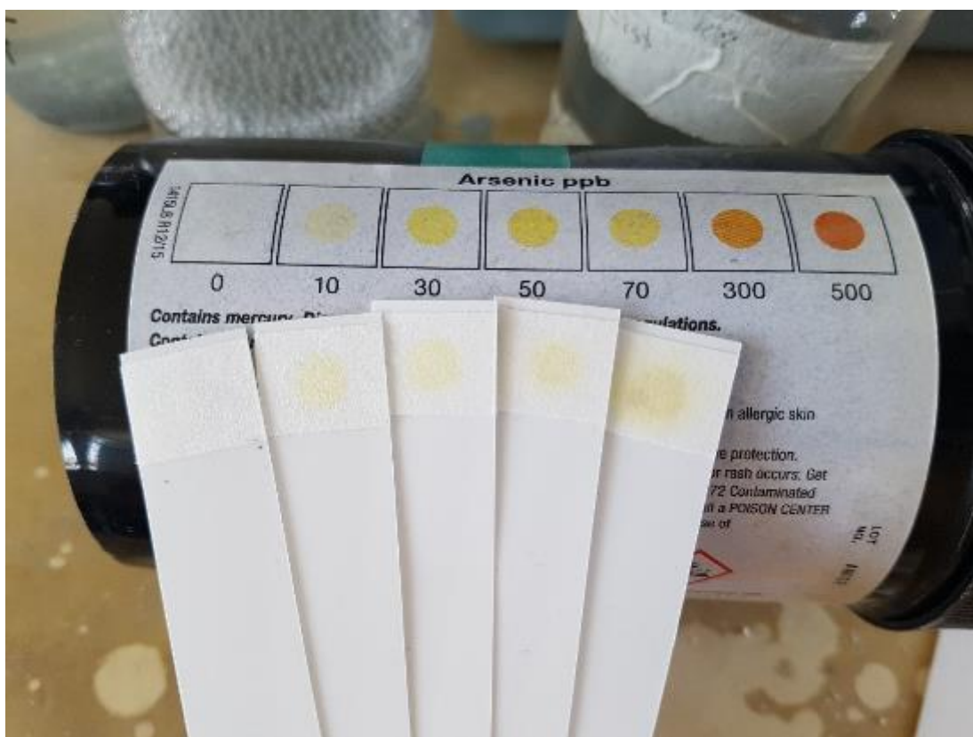
Figura N° 55: Resultados de coloración en las distintas concentraciones de arsénico en parte por billón.
