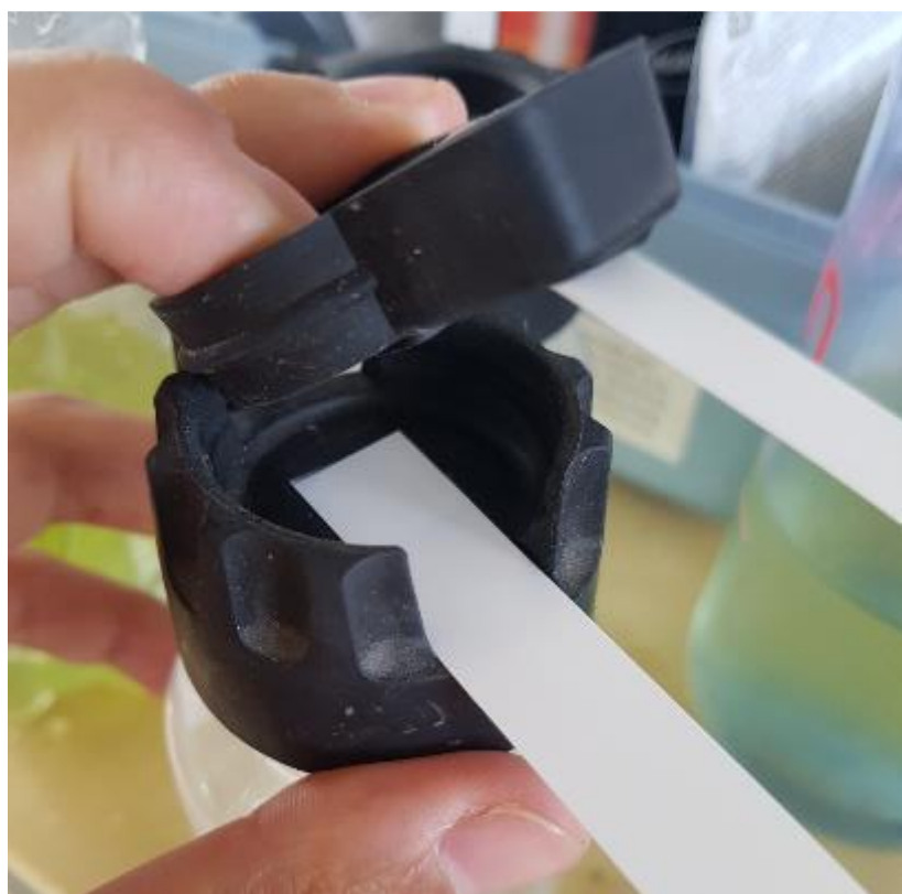
Figura N° 53: Test Kit de Hach, tira de coloración
