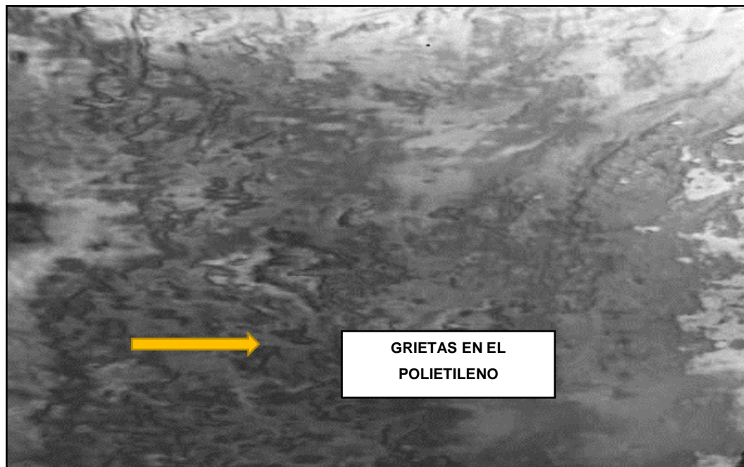
Figura 10 Microfotografía SEM de PEBD, de perlas de polietileno de baja densidad colonizado por bacterias y recubierto de biofilm bacteriano a 500x.
