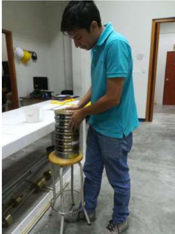
Fotografía N° 7: Ensayo de granulometría - zarandeo
