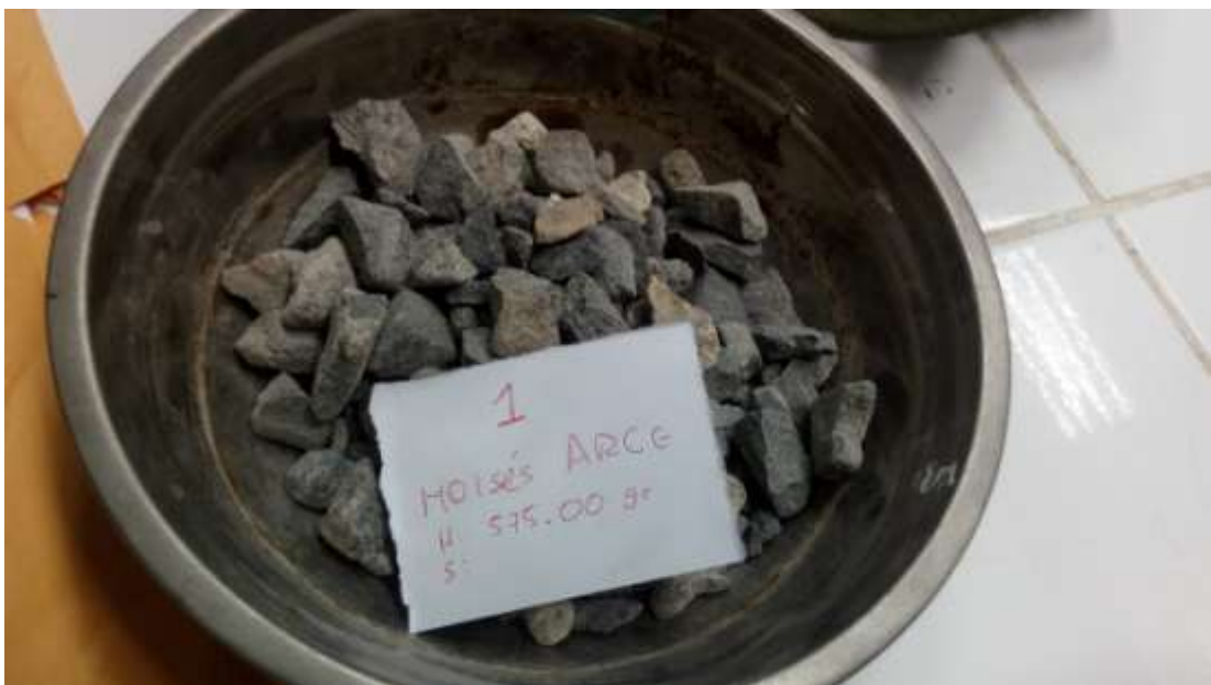
Fotografía N° 4: Ensayo de humedad natural
