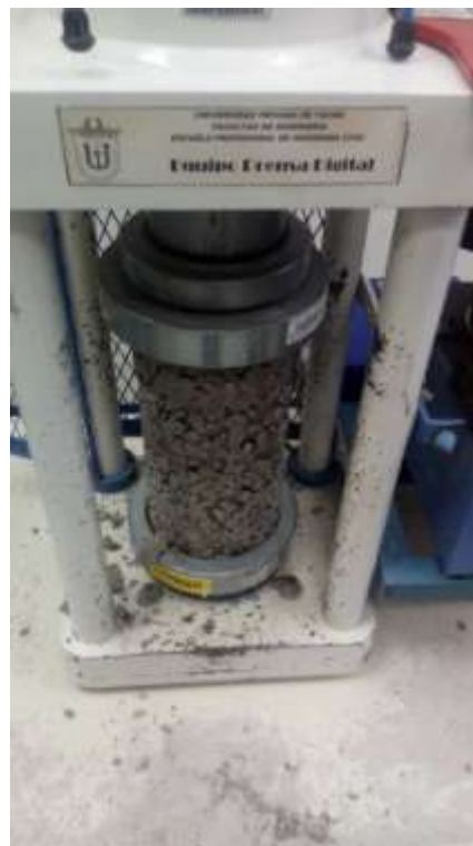
Fotografía N° 12: Testigo cilíndrico de concreto permeable sometido a ensayo de resistencia a la compresión.
