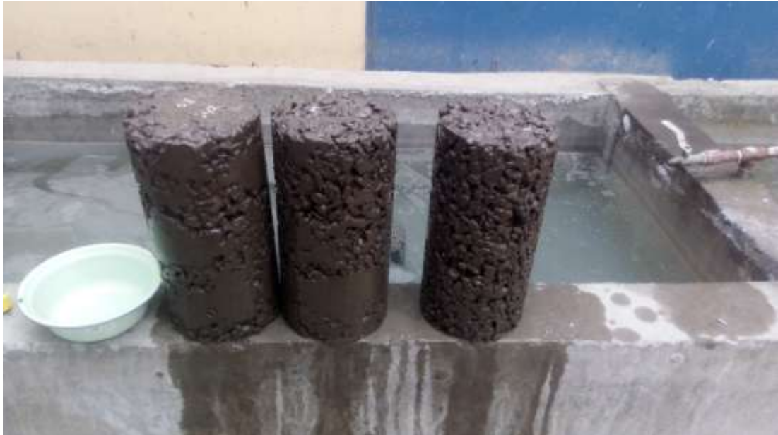
Fotografía N° 11: Testigos cilíndricos de concreto permeable retirados de la poza para ensayo de resistencia a la compresión.
