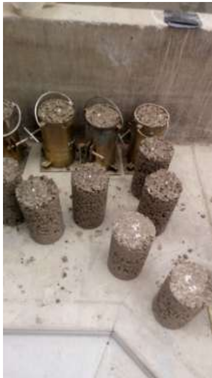
Fotografía N° 10: Testigos cilíndricos de concreto permeable
