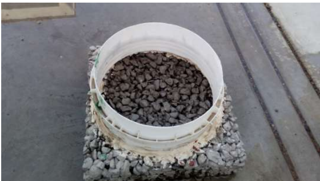
Fotografía N° 14: Ensayo de permeabilidad.
