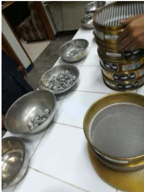
Fotografía N° 8: Ensayo de granulometría – cantidad retenida
