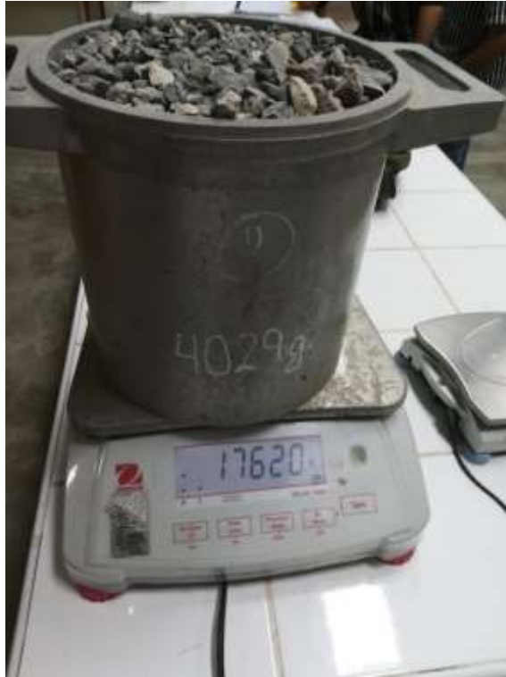
Fotografía N° 5: Ensayo de peso unitario suelto
