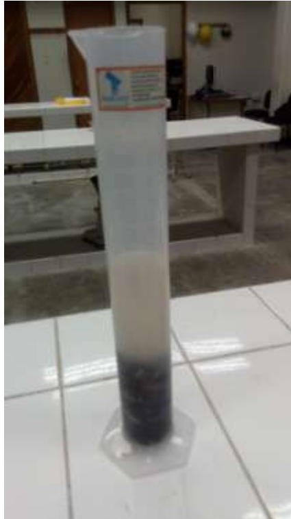
Fotografía N° 9: Ensayo peso específico
