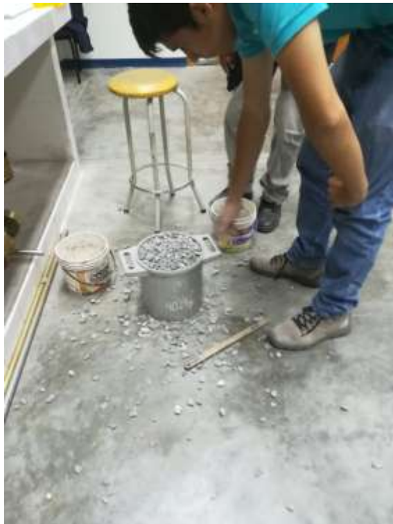
Fotografía N° 6: Ensayo de peso unitario varillado
