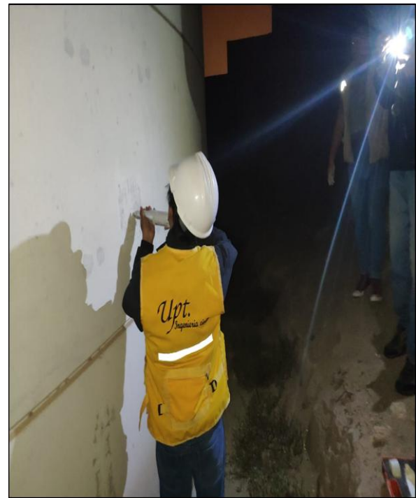
Fotografía 92. Despliegue del émbolo de impacto – R14. Fuente: Elaboración propia.
