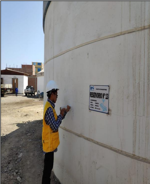
Fotografía 89. Despliegue del émbolo de impacto – R13. Fuente: Elaboración propia.
