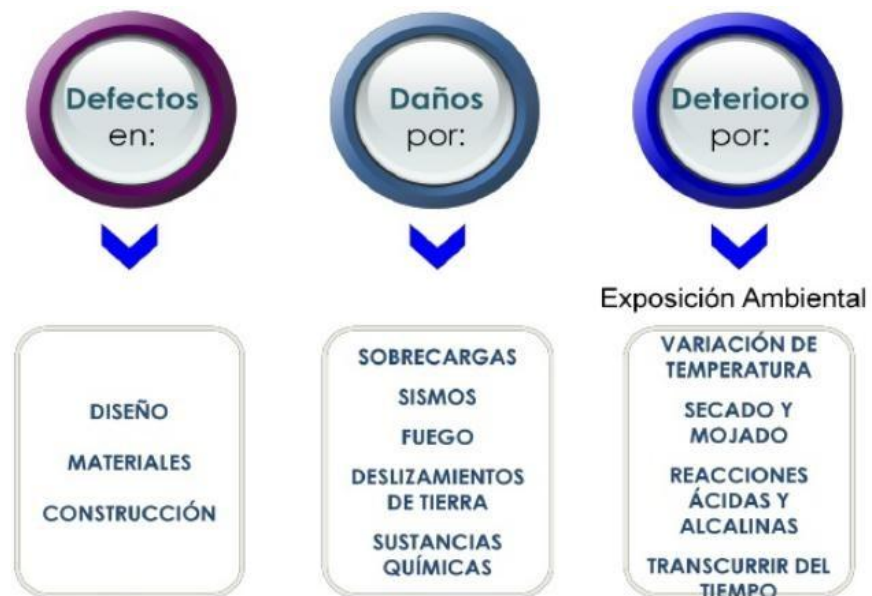
Figura 3. Clasificación general de patologías en las edificaciones. Fuente: (Astorga & Rivero, 2009)
