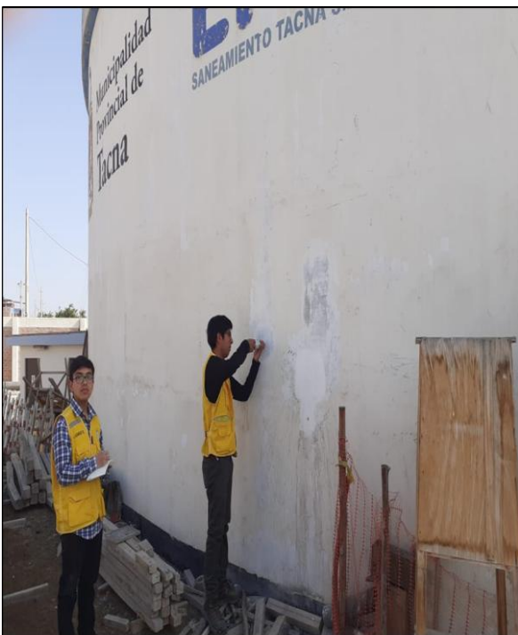
Fotografía 91. Despliegue del émbolo de impacto – R15. Fuente: Elaboración propia.
