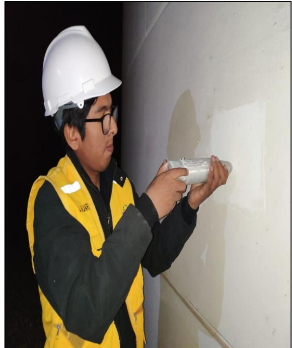
Fotografía 90. Despliegue del émbolo de impacto – R10. Fuente: Elaboración propia.
