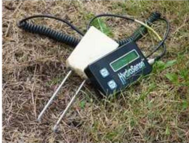
Figura 10. "Sensor con tecnología TDR." Fuente: labmodules.soilweb.ca
