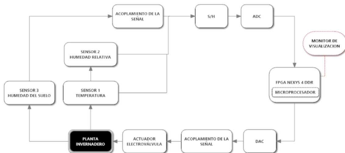
Figura 18. “Diagrama de bloques del sistema de control climático y riego propuesto.” Fuente: Elaboración propia.
