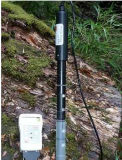
Figura 11. "Sensor con tecnología FDR." Fuente: Experimental-hydrology.net
