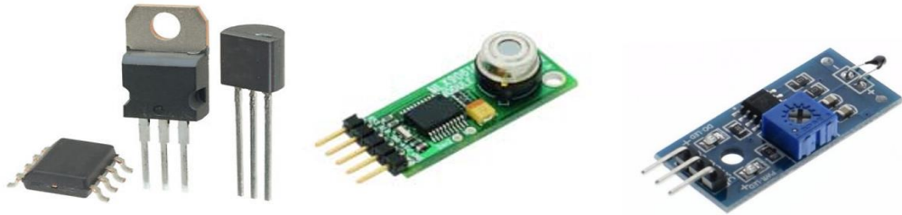
Figura 6. “Tipos de circuitos integrados de temperatura y humedad relativa.”
