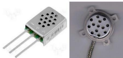
Figura 9. "Tipos de sensores de humedad de conductividad térmica. Fuente: Grandtech.
