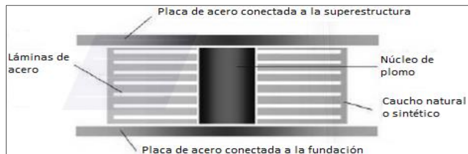
Figura 09. Aislador elastomérico con núcleo de plomo (LRB)
