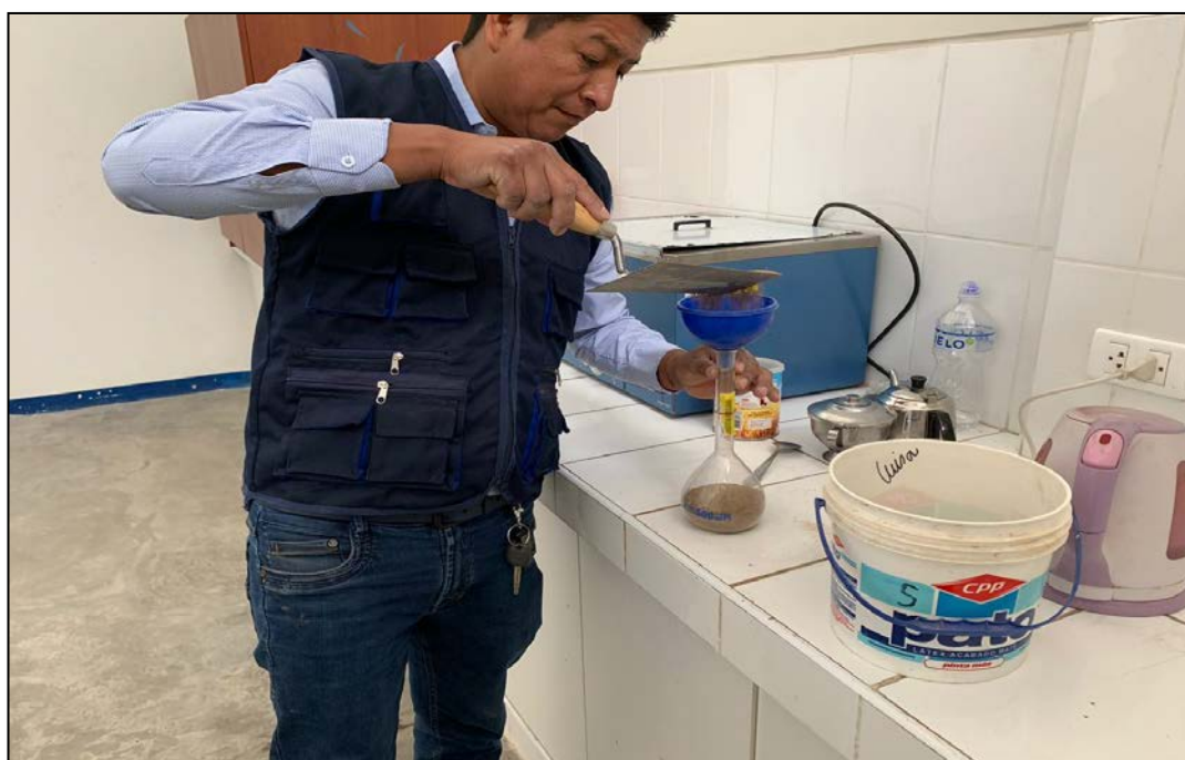
FIGURA N°33: La fiola previamente tarado y se determina su peso; en seguida se llena de agua hasta un 90% aproximadamente de su capacidad.
