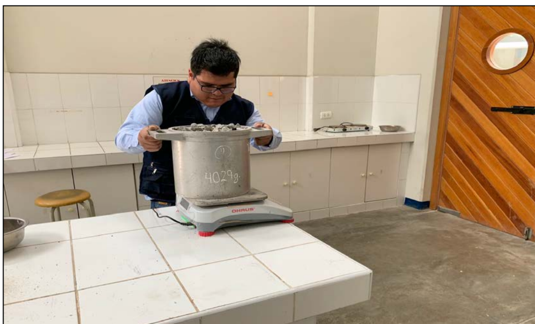
FIGURA N°48: Colocar la piedra en el molde sin compactar.
