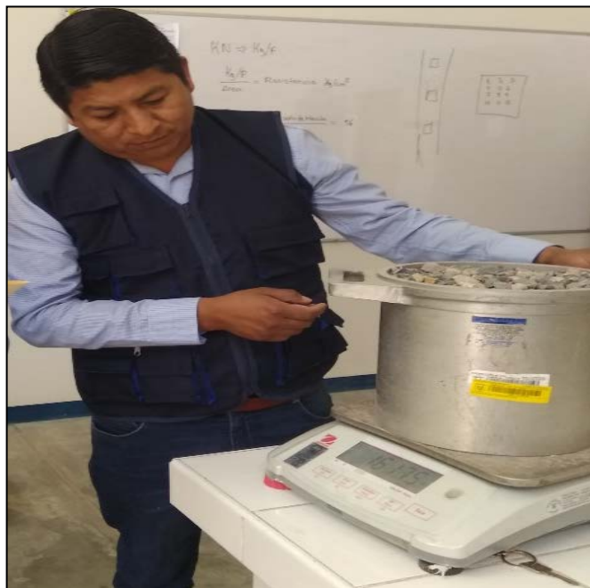
FIGURA N°56: Finalmente se pesa el molde contenido con el agregado grueso.
