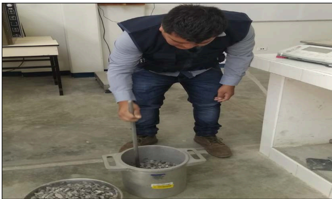
FIGURA N°54: Sin que el apisonador choque a la base o altere capas inferiores de agregado.
