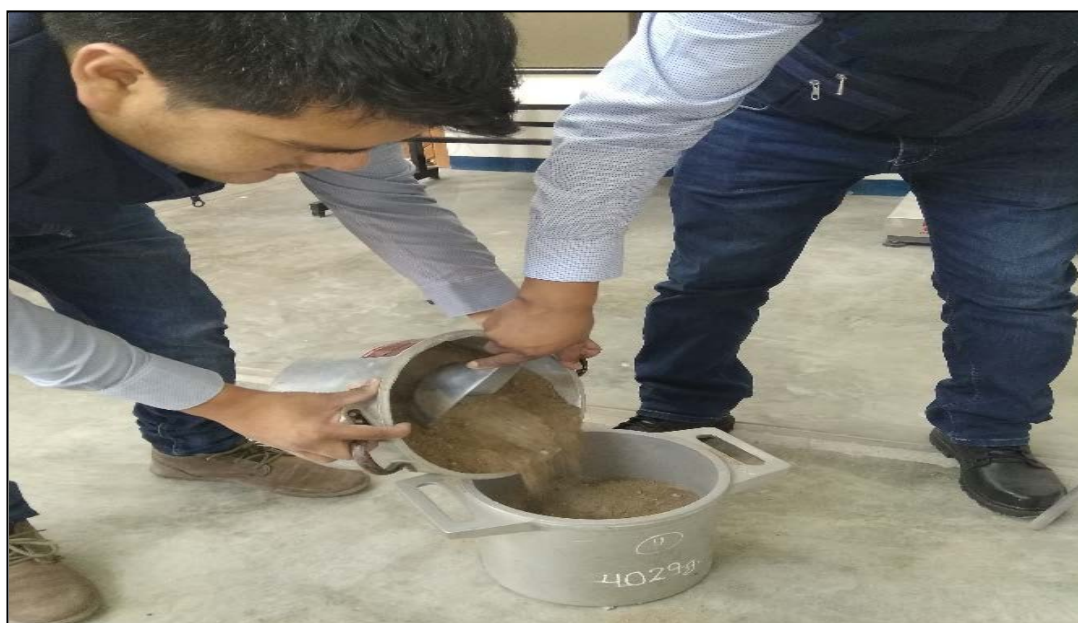
FIGURA N°41: Se coloca la arena en el molde sin compactar.
