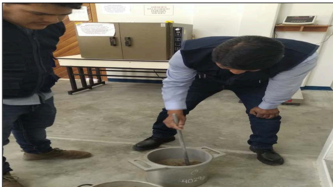
FIGURA N°44: En cada capa se empareaja con la mano y se apisona con 25 golpes de manera uniforme.
