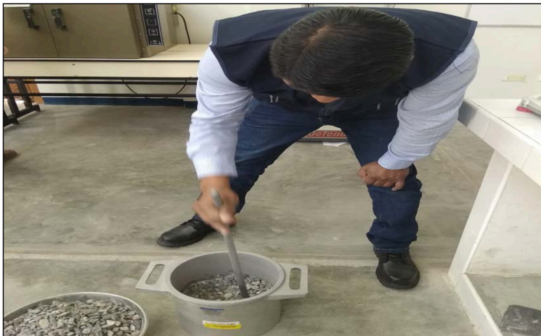
FIGURA N°53: Cada capa recibe un total de 25 golpes con el apisonador.
