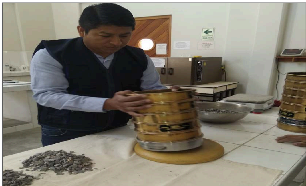
FIGURA N°29: Cada cantidad retenida de agregado se pesa, incluyendo lo que queda en la base.
