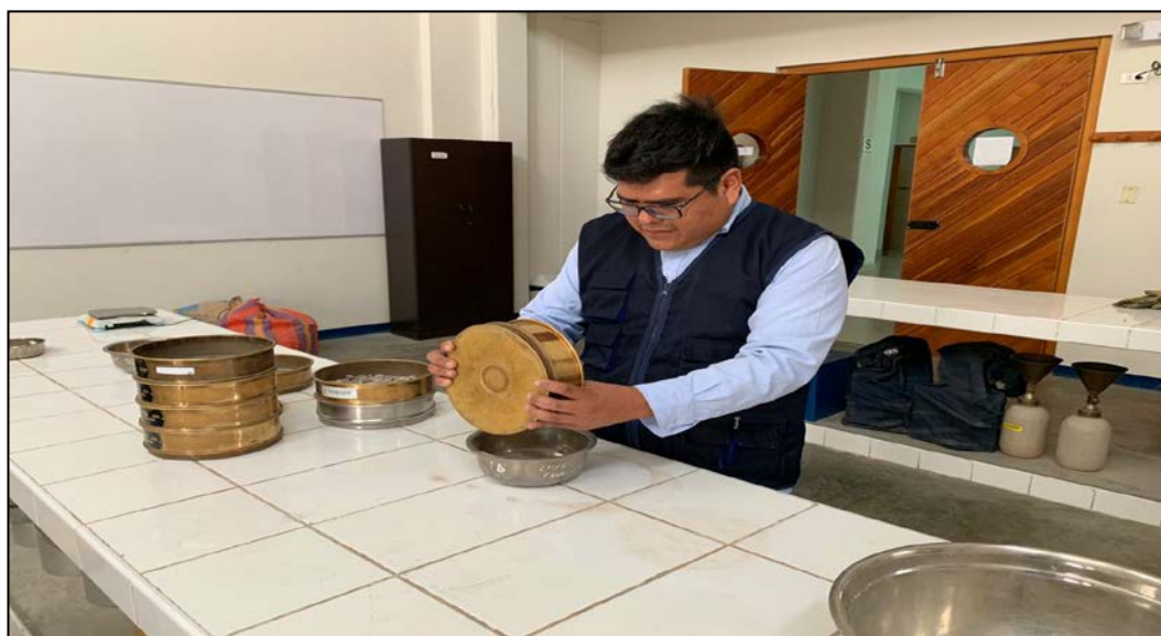
FIGURA N°24: Cada cantidad retenida de agregado se pesa, incluyendo lo que queda en la base.
