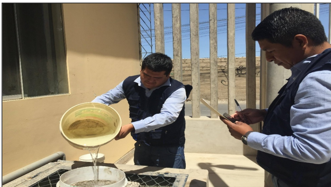
FIGURA N°67: Colocamos en la base un aro el cual tenemos su área y en otro envase una cantidad de agua.
