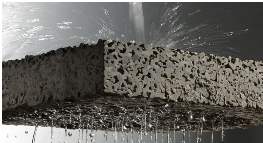
FIGURA N°01: Losa de Concreto Permeable.
