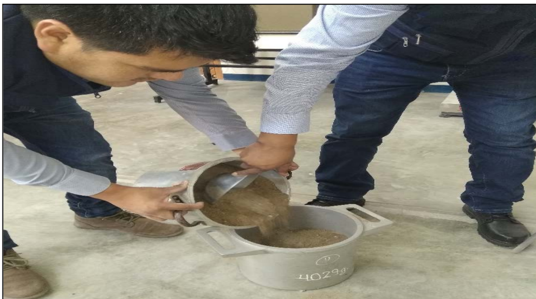
FIGURA N°43: Primero se determina el peso y volumen del molde y luego se coloca la arena en tres capas.
