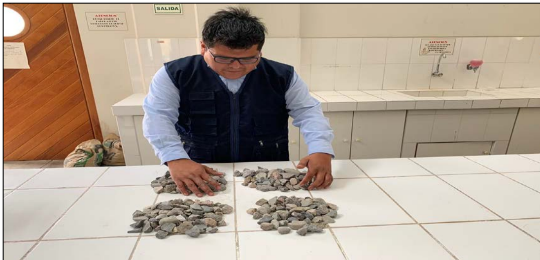
FIGURA N°18: Se cuartea el material (Agregado Grueso).
