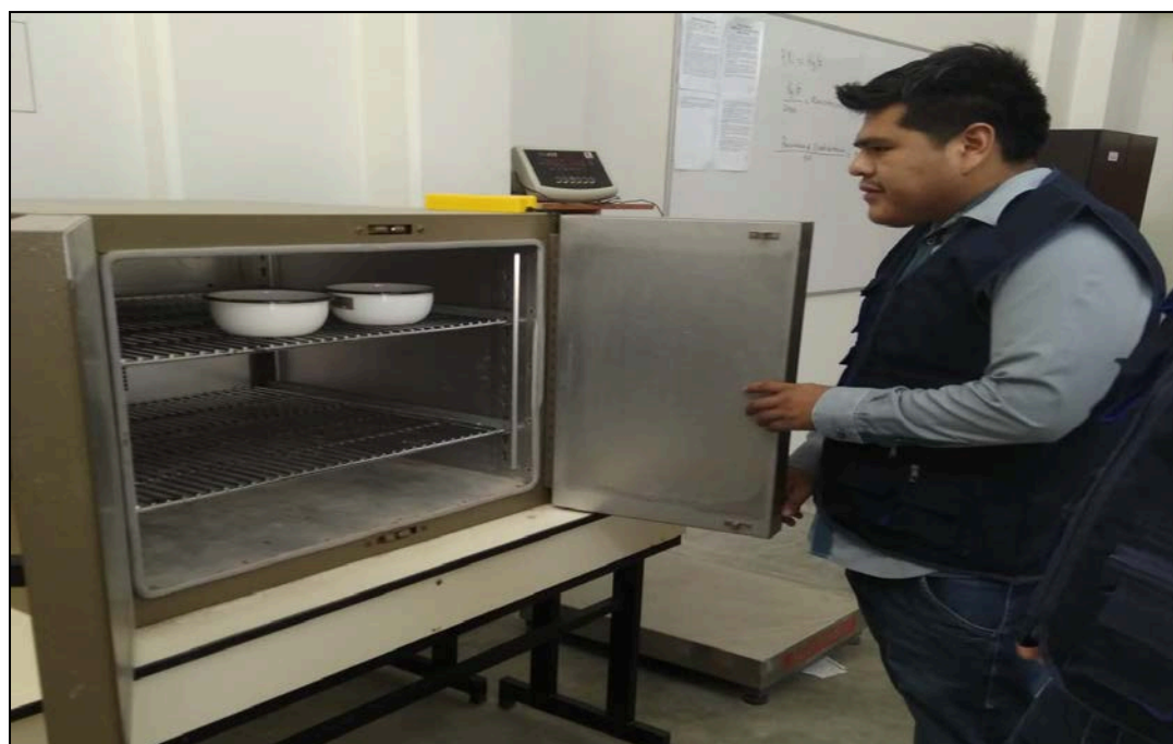
FIGURA N°19: Se coloca en el horno el material durante 24 horas.
