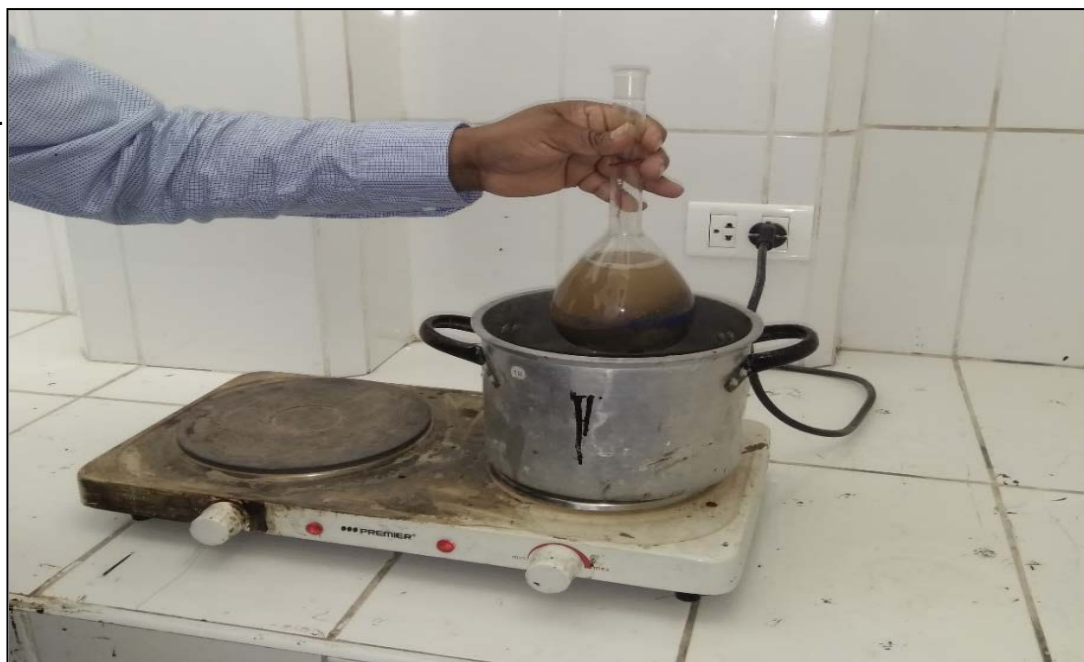
FIGURA N°34: Se retira el aire atrapado girando la fiola y sometiéndolo a baño maría.
