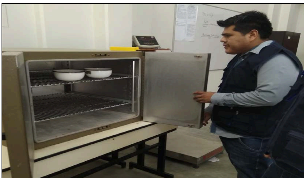
FIGURA N°17: Se coloca las muestras de Agregado Fino al Horno.
