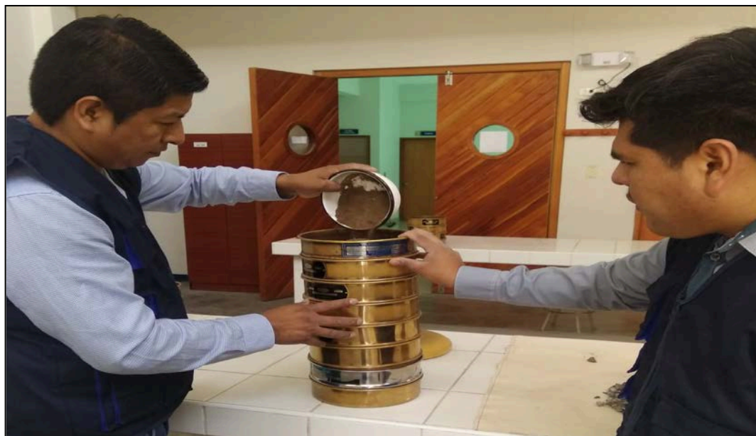
FIGURA N°21: La muestra para someterse al tamizado fue lavada y secada por un periodo de 24 horas.
