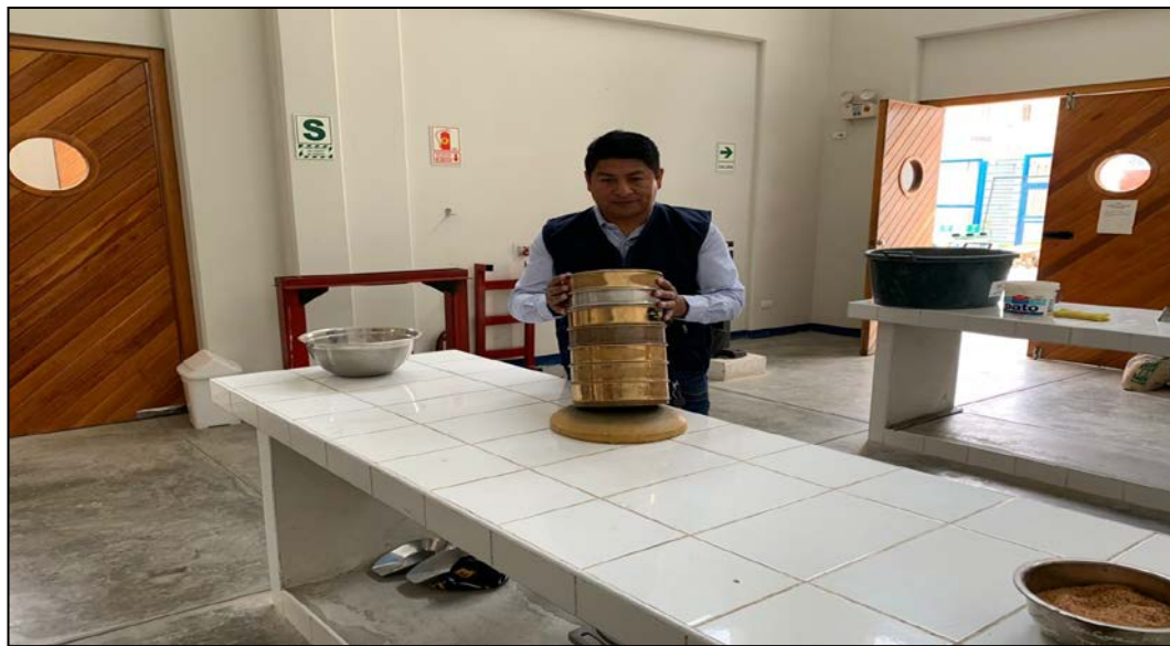
FIGURA N°23: Se comienza el proceso con ligeros golpes y girando el conjunto hasta obtener peso constante en cada tamiz.
