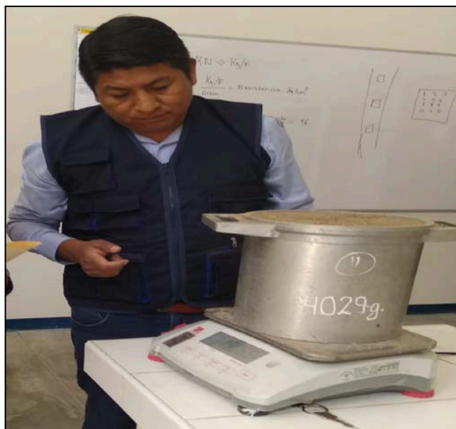
FIGURA N°46: Y finalmente se pesa el molde contenido con arena compactada.
