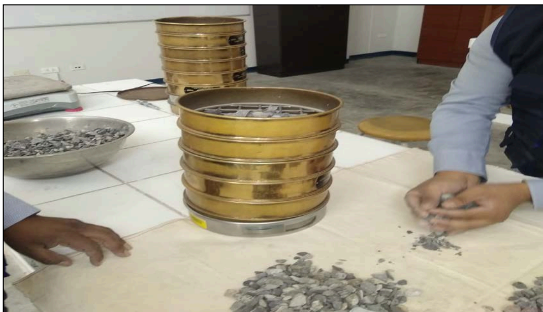
FIGURA N°27: Se vierte el agregado grueso a los tamices.
