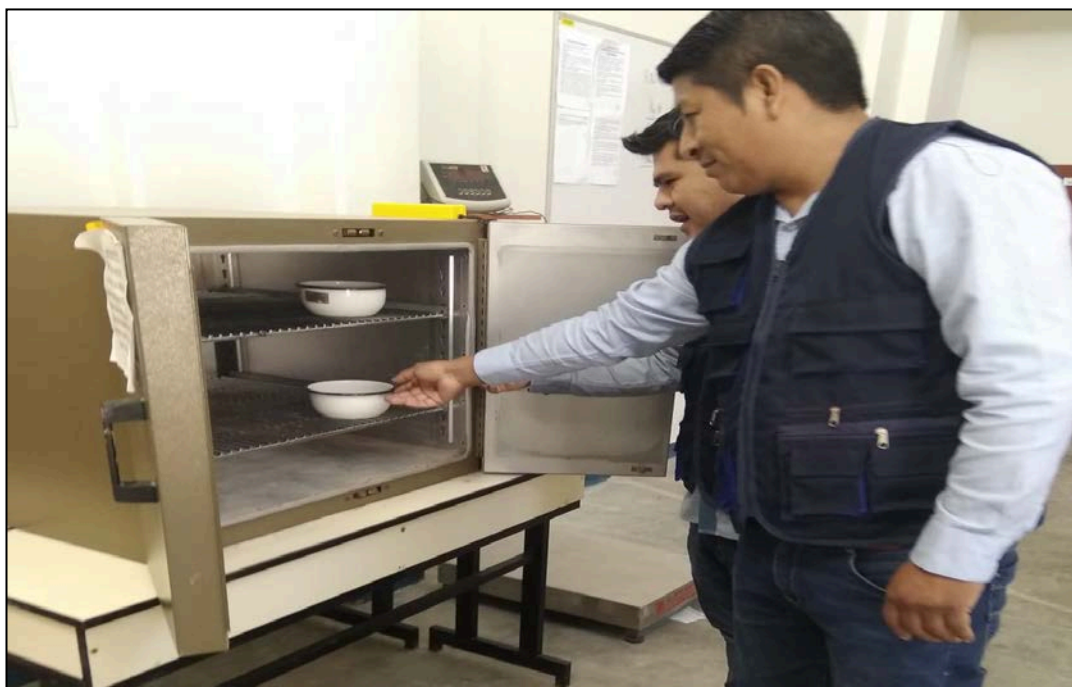
FIGURA N°39: A continuación este mismo material se seca en un horno por 24 horas y se determina, también, su peso seco.
