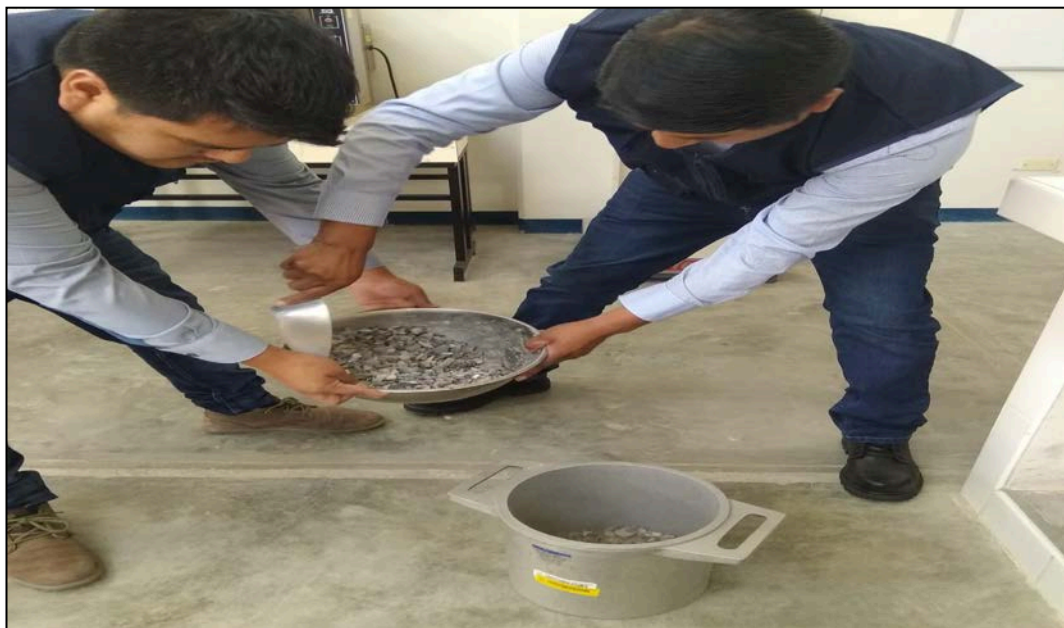
FIGURA N°51: Primero se pesa el molde para luego colocar el agregado grueso. FUENTE: Elaboración Propia, 2017.
