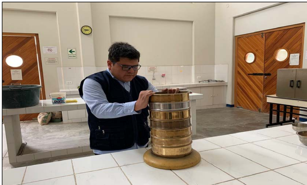
FIGURA N°28: Se comienza el proceso con ligeros golpes y girando el conjunto hasta obtener peso constante en cada tamiz.
