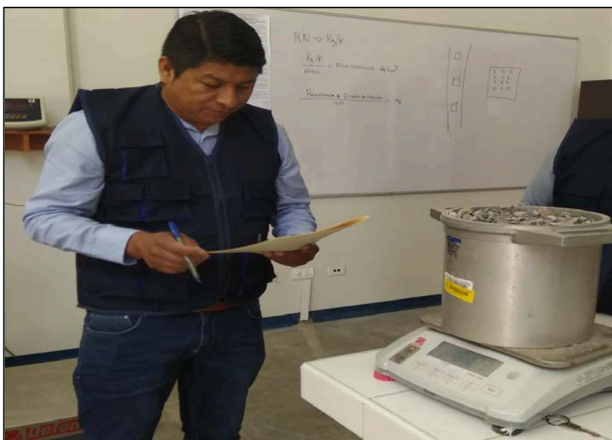
FIGURA N°50: Pesar el molde por la Balanza Electrónica el contenido con el agregado grueso.
