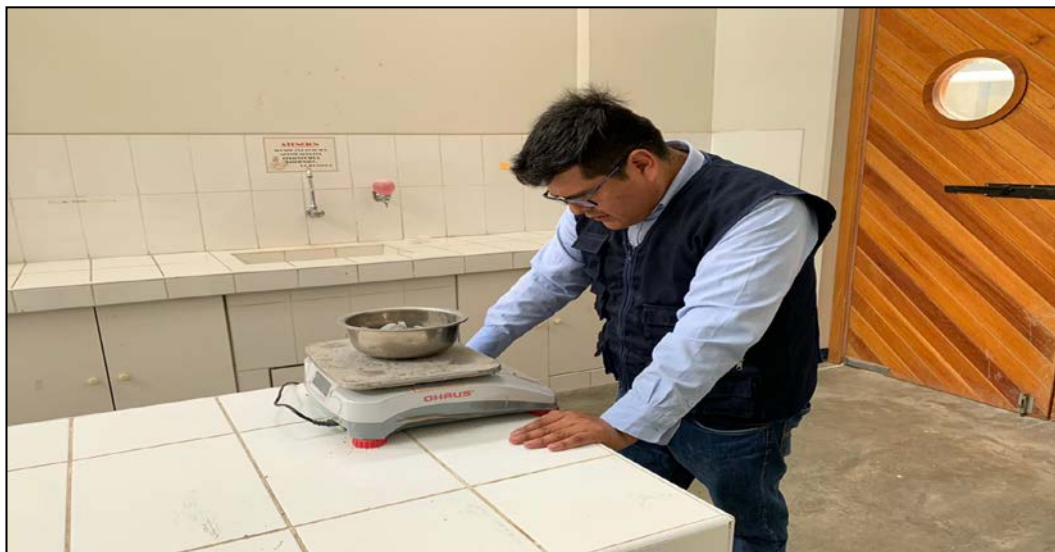
FIGURA N°36: Se toma cierto porcentaje de la muestra, aproximadamente 600gr.
