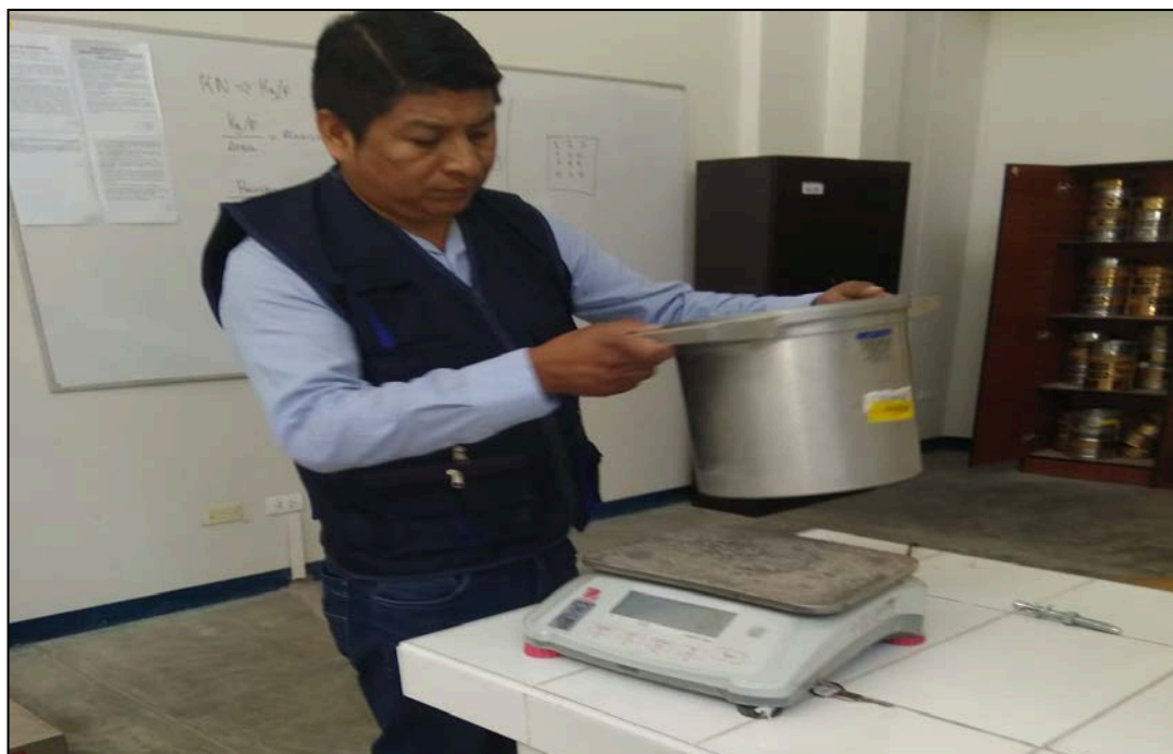
FIGURA N°40: Se escoge un molde de dimensiones adecuadas se determina su peso y dimensiones de tal manera que se pueda lograr su volumen.
