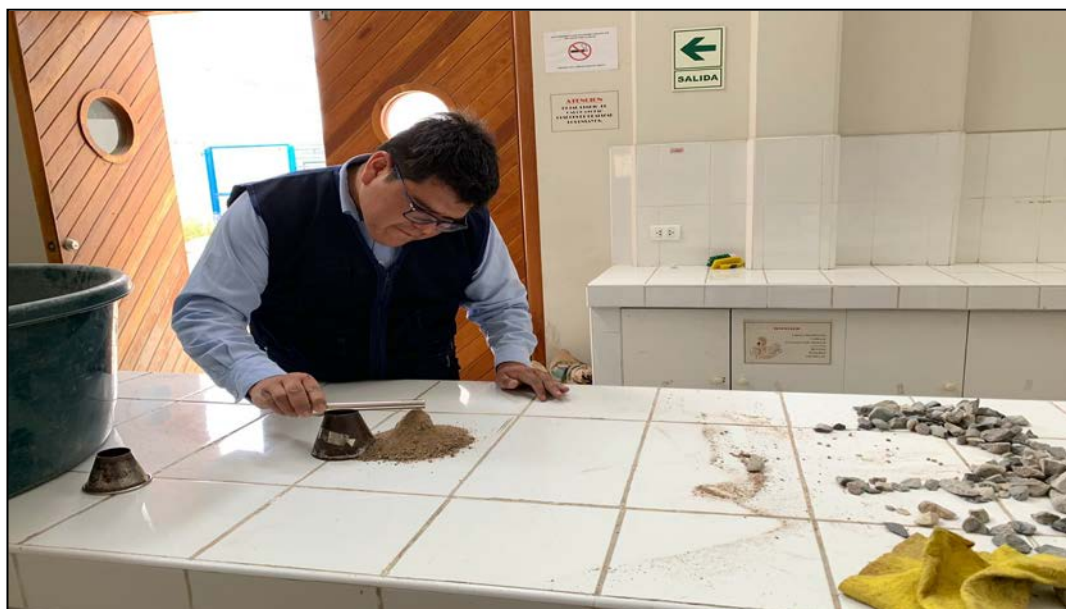
FIGURA N°31: Se toma el material y se rellena el tronco de cono cuidadosamente y se apisona con 25 golpes sobre la superficie, se retira el cono y se verificará el primer desmoronamiento.
