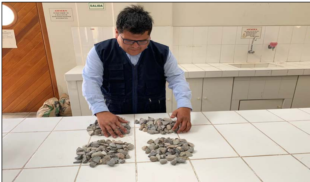
FIGURA N°26: La muestra para someterse al tamizado fue lavada y secada por un periodo de 24 horas.
