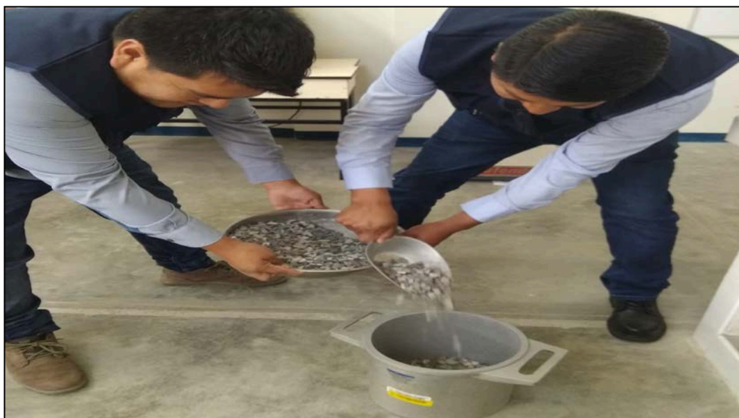
FIGURA N°52: Se colocará el material en tres capas de igual volumen. FUENTE: Elaboración Propia, 2017.
