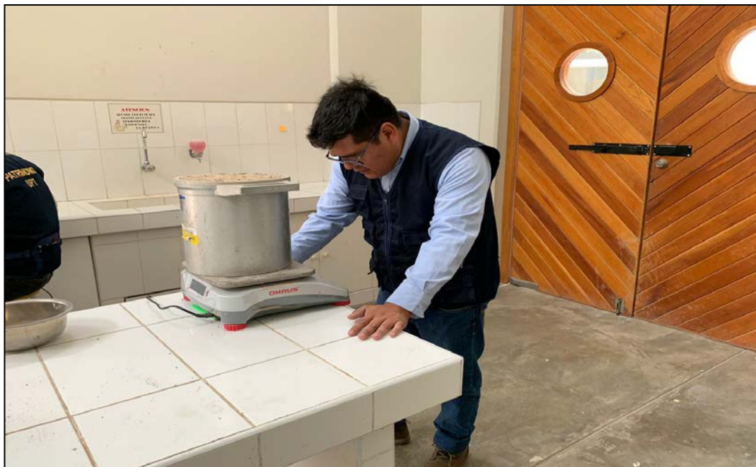
FIGURA N°42: Una vez que esté lleno el molde enrasar la superficie con la varilla y se pesa el molde contenido de arena.
