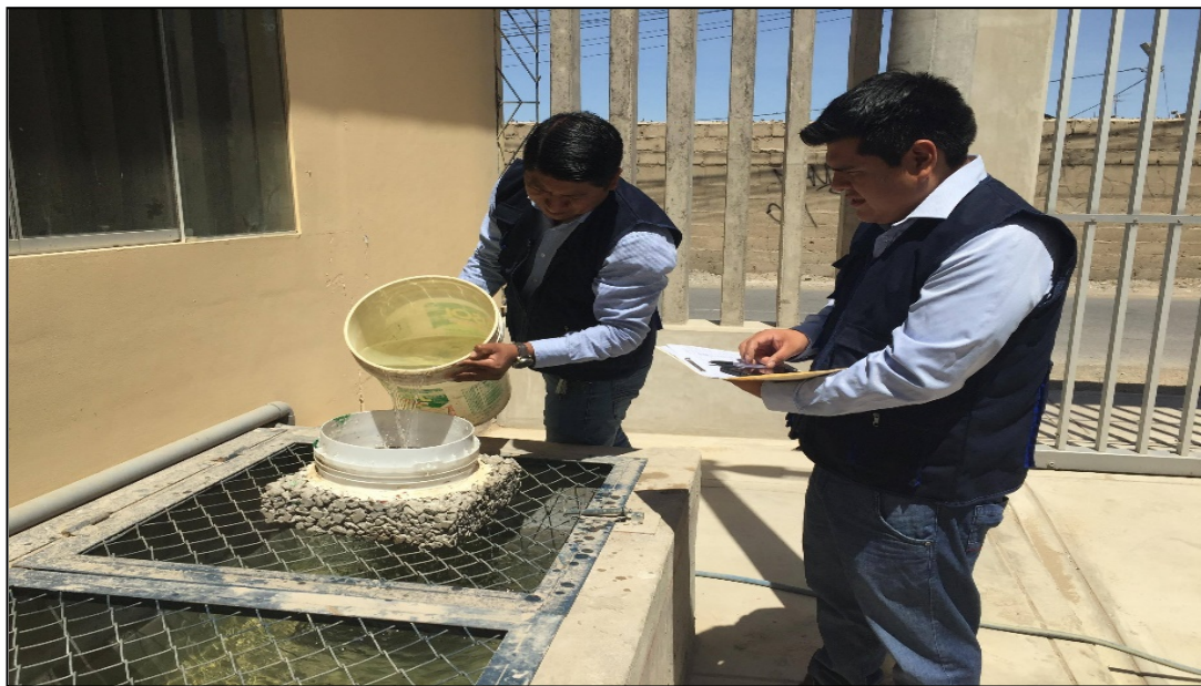
FIGURA N°68: Vertimos una cantidad de agua en el aro y calculamos el tiempo de filtración sobre la losa.
