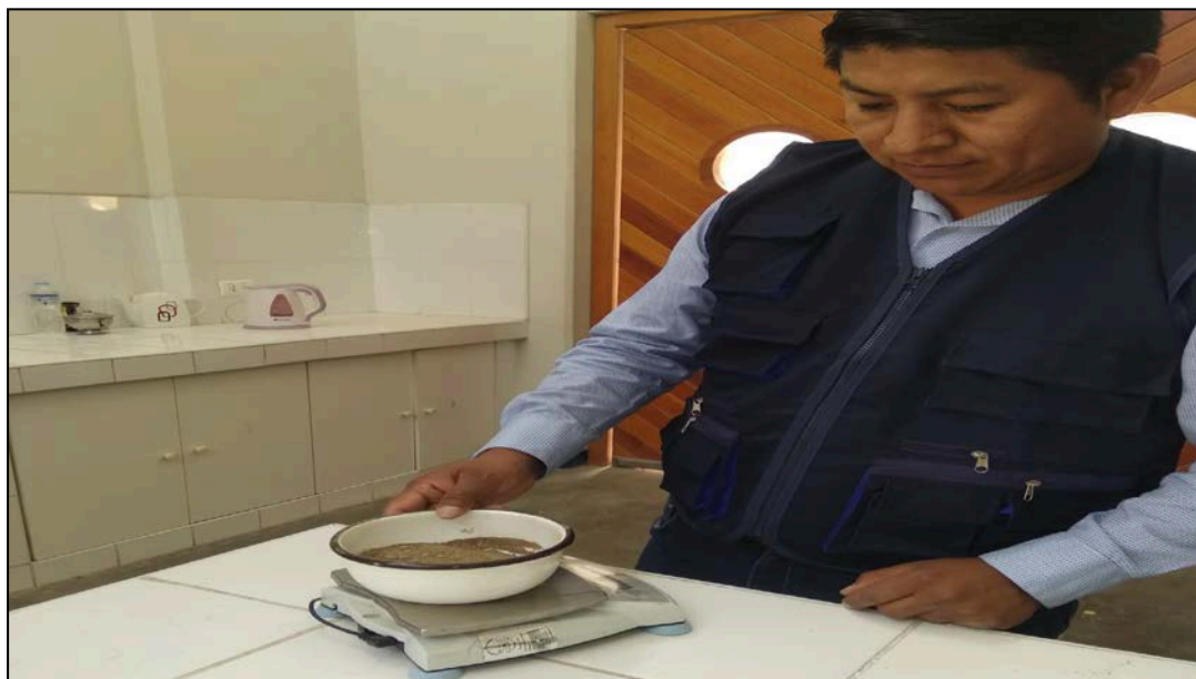
FIGURA N°30: Se escoge una muestra, confirmándose que es el material pasante de la malla N° 4.
