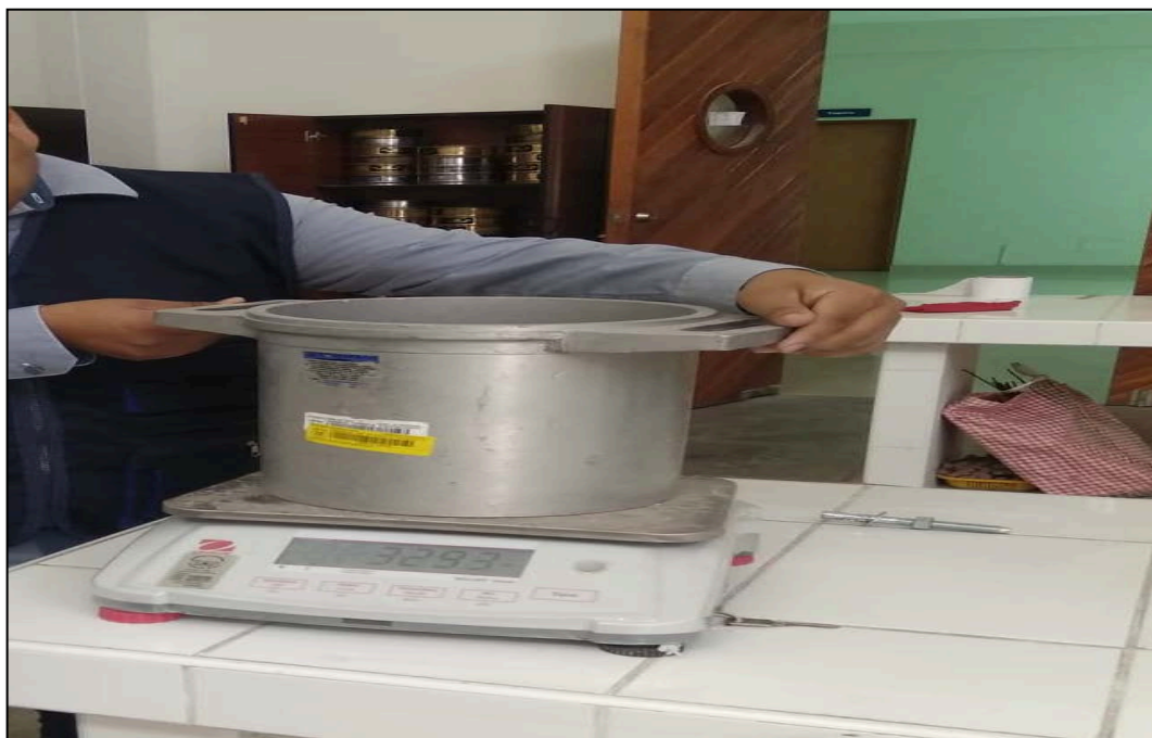
FIGURA N°47: Primero se determina el peso y el volumen del molde.
