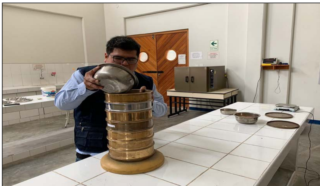
FIGURA N°22: Se vierte el agregado fino a los tamices.
