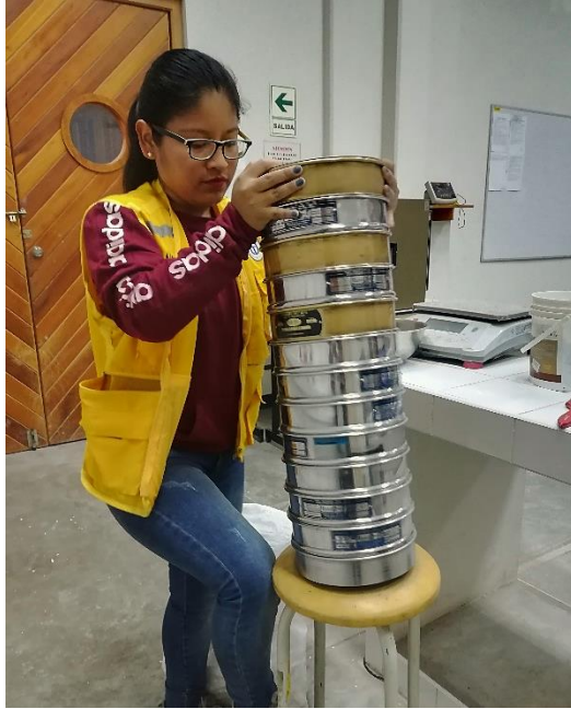
Fotografía 5 Ensayo de granulometría del agregado fino
