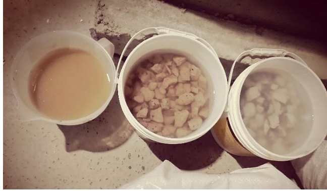
Fotografía 10 Muestras sumergidas en agua que se utilizarán para ensayos de peso específico y absorción
