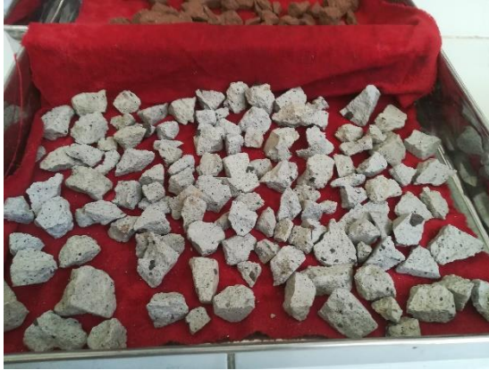
Fotografía 13 Secado del agregado (sillar blanco) para ensayo de peso específico
