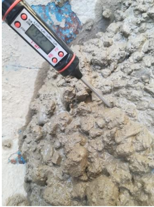
Fotografía 32 Medición de temperatura en estado fresco del concreto
