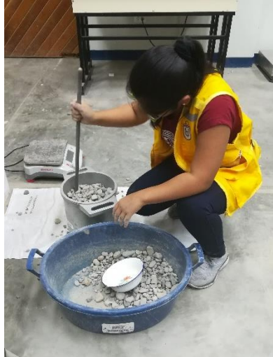
Fotografía 16 Ensayo de peso unitario compactado del agregado grueso (grava)
