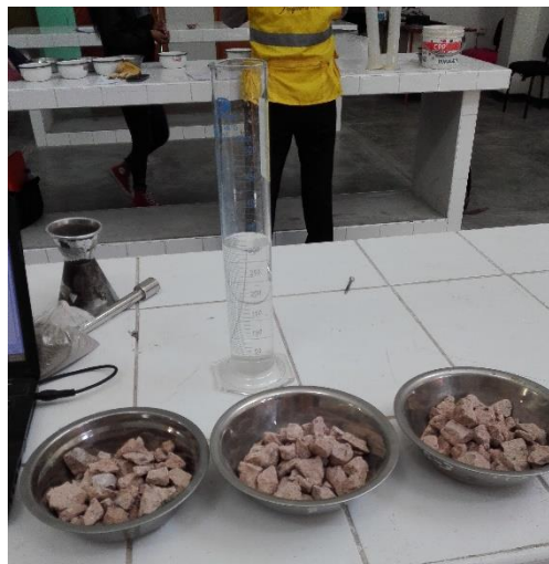
Fotografía 12 Ensayo de peso específico del agregado grueso (sillar rosado)
