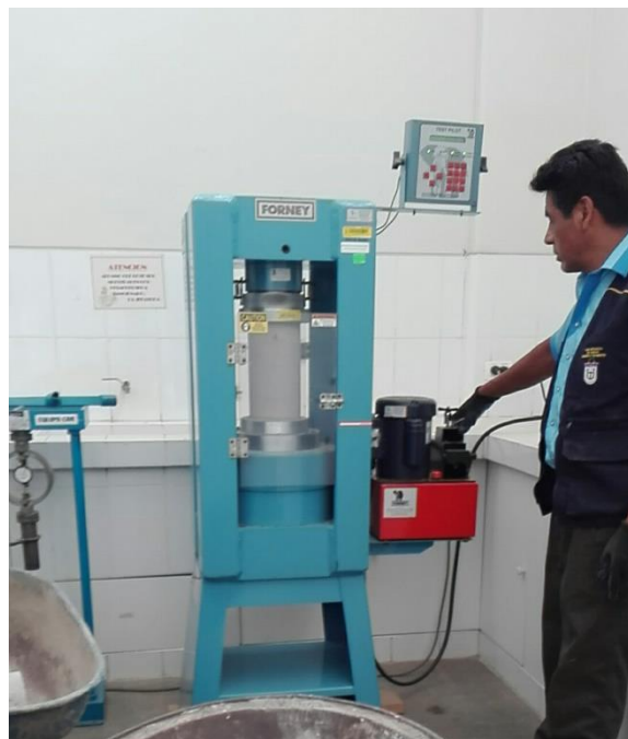
Fotografía 29 Ensayo de compresión a los 28 días
