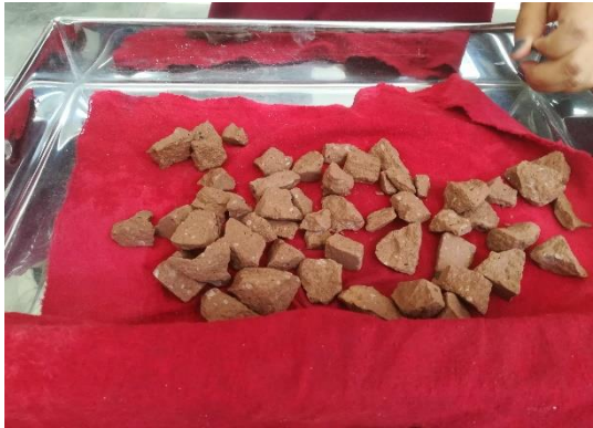
Fotografía 14 Secado del agregado (sillar rosado) para ensayo de peso específico
