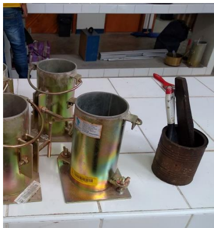
Fotografía 18 Antes de vaciar la mezcla a los moldes se debe cubrir el interior con petróleo
