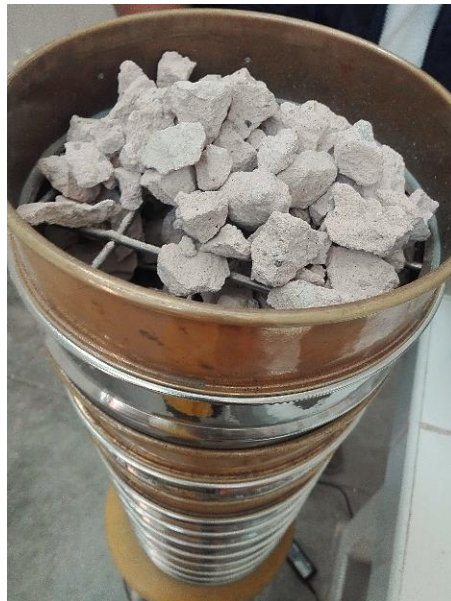
Fotografía 6 Ensayo de granulometría del agregado grueso (sillar blanco)
