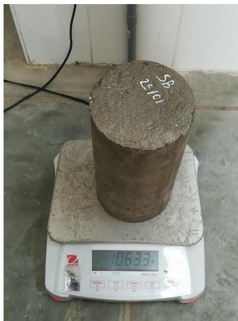
Fotografía 25 Cumplido el tiempo de curado, se sacan los testigos del agua se pesan y se toma la medida de la altura y diámetro de los testigos de concreto
