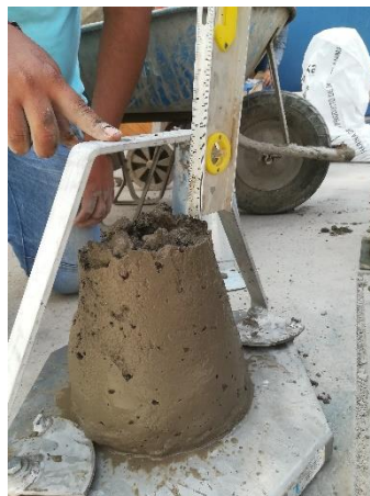
Fotografía 21 Realizamos prueba de slump
