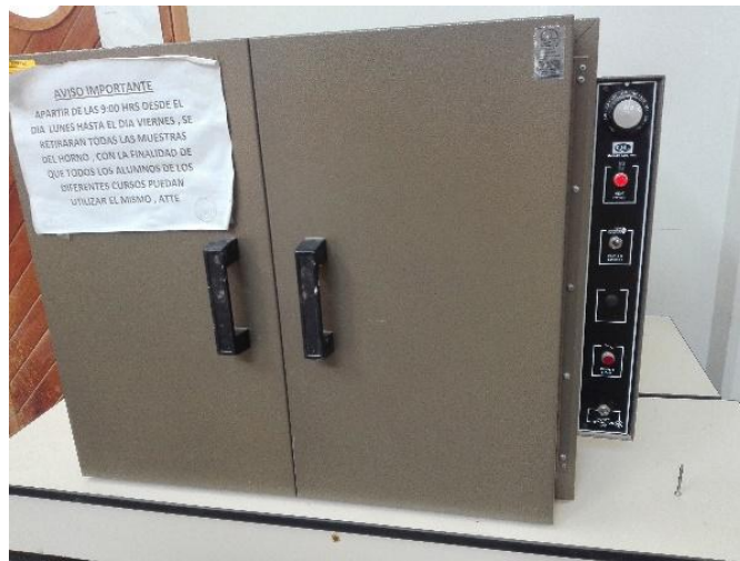
Fotografía 4 Horno utilizado para los ensayos de contenido de humedad y absorción.
