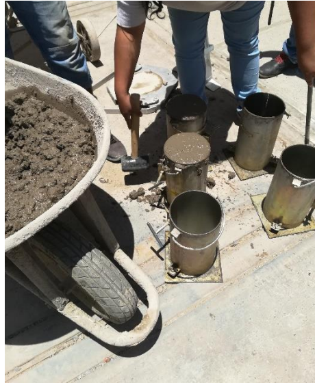
Fotografía 22 Se coloca la mezcla en 3 capas, en cada capa dar 25 golpes con la varilla de 5/8"
