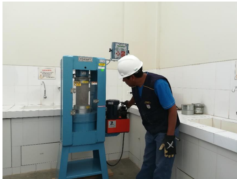
Fotografía 27 Ensayo de compresión a las 7 días
