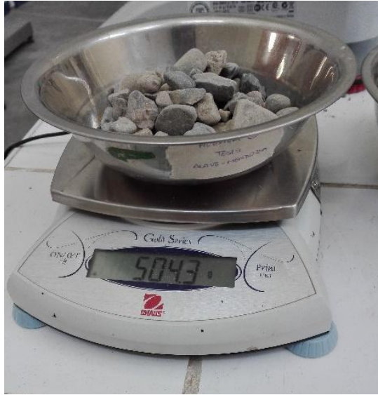
Fotografía 3 Se pesan muestras representativas para el ensayo de humedad del agregado grueso
