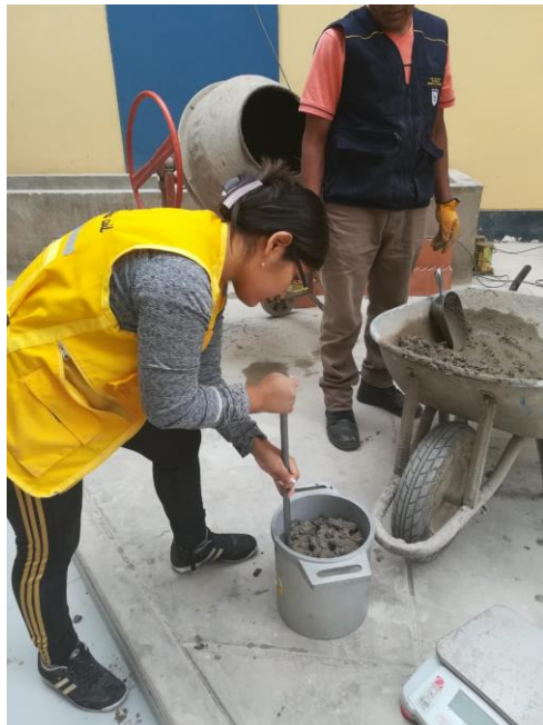
Fotografía 33 Ensayo de peso unitario del concreto fresco
