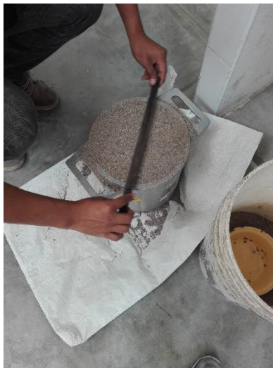
Fotografía 15 Ensayo de peso unitario suelto del agregado fino
