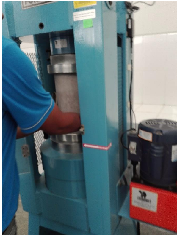
Fotografía 28 Ensayo de compresión a los 14 días
