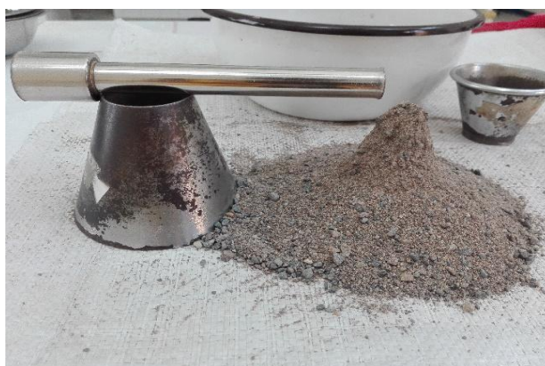
Fotografía 8 Ensayo de absorción del agregado fino
