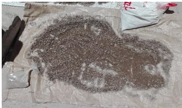
Fotografía 7 Secado del material al aire libre para realizar el ensayo de absorción del agregado fino
