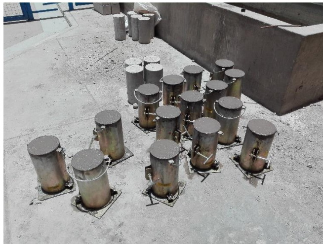
Fotografía 23 Culminación de la elaboración de los primeros 15 moldes de concreto
