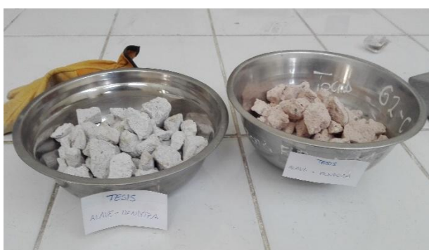
Fotografía 9 Muestras listas para realizar el ensayo de absorción del agregado grueso (sillares)
