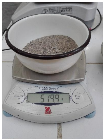
Fotografía 2 Se pesan muestras representativas para el ensayo de humedad del agregado fino
