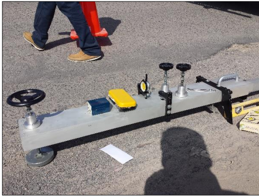
Fotografías 23: Equipo de viga Benkelman (doble brazo) y volquete con un peso aproximado de 8200 kg
