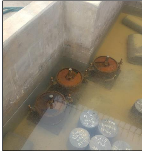
Fotografías 31: Sumergiendo en agua las 3 muestras de suelo compactado por 96 horas.
