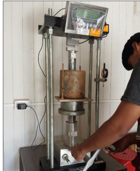
Fotografías 32: Ajustando el equipo para realizar las lecturas, para luego determinar el CBR.
