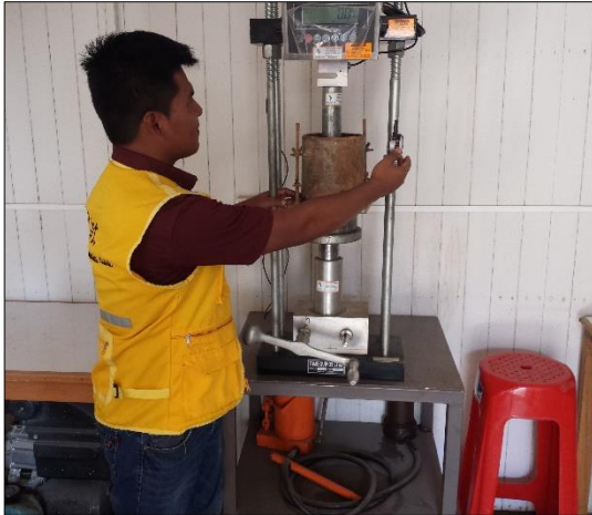
Fotografías 32: Ajustando el equipo para realizar las lecturas, para luego determinar el CBR.
