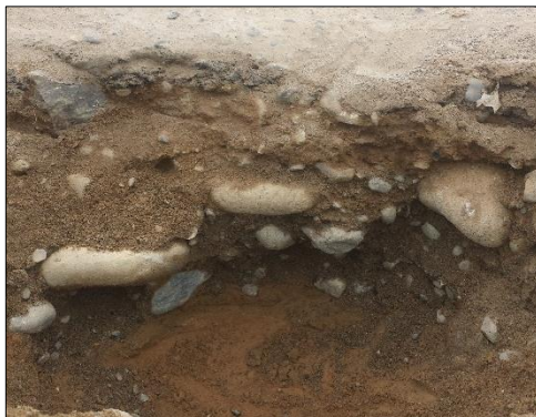
Fotografías 33: Midiendo el espesor de la base (20 cm) y el espesor de la carpeta asfáltica (5.0 cm).
