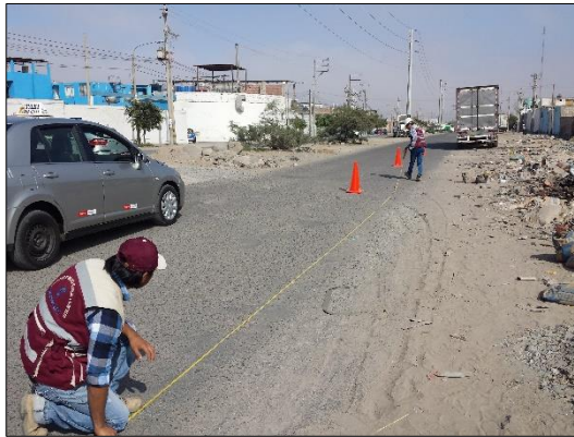
Fotografías 24: Marcando los puntos y posicionamiento de la viga de Benkelman.
