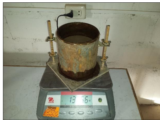
Fotografías 30: Se pesó una muestra de suelo para el ensayo de CBR y luego se pesó la muestra compactada.
