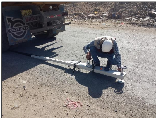
Fotografías 25: Ajustando los diales de lectura y nivelando la viga Benkelman.
