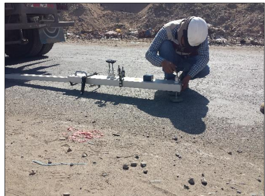
Fotografías 25: Ajustando los diales de lectura y nivelando la viga Benkelman.
