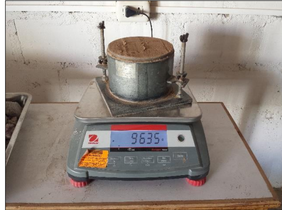
Fotografías 29: Se realizó 56 por cada capa posteriormente se pesó la muestra.
