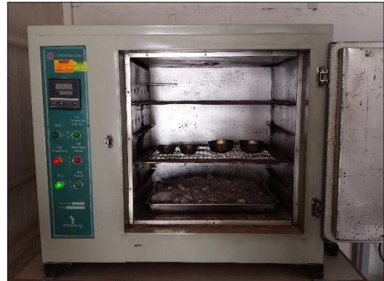
Fotografías 29: Se pesó una muestra húmeda y luego se procedió a secarlo en el horno.
