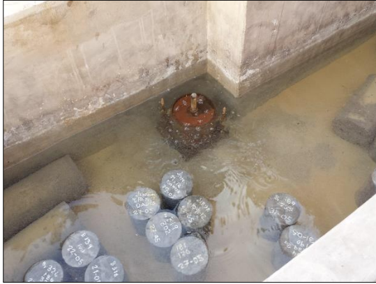
Fotografías 31: Sumergiendo en agua las 3 muestras de suelo compactado por 96 horas.
