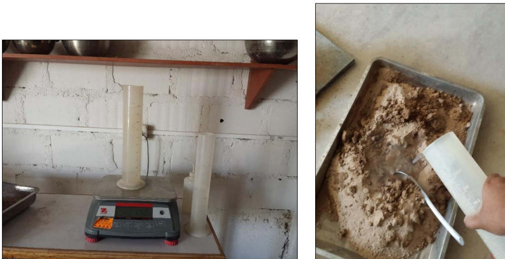
Fotografías 28: Se agregó 4% de agua para el primer ensayo.
