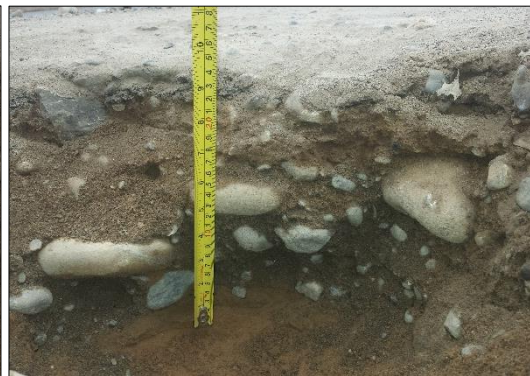
Fotografías 33: Midiendo el espesor de la base (20 cm) y el espesor de la carpeta asfáltica (5.0 cm).
