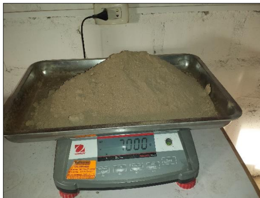
Fotografías 30: Se pesó una muestra de suelo para el ensayo de CBR y luego se pesó la muestra compactada.
