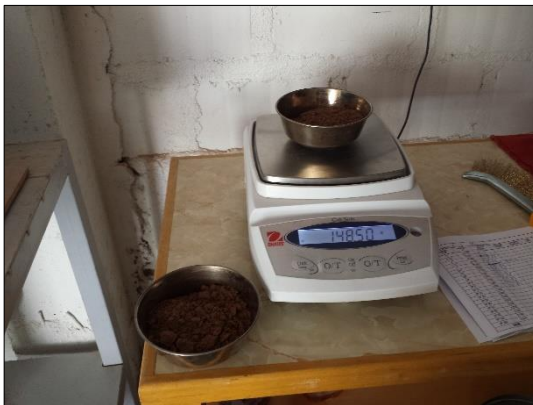
Fotografías 29: Se pesó una muestra húmeda y luego se procedió a secarlo en el horno.
