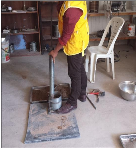
Fotografías 29: Se realizó 56 por cada capa posteriormente se pesó la muestra.
