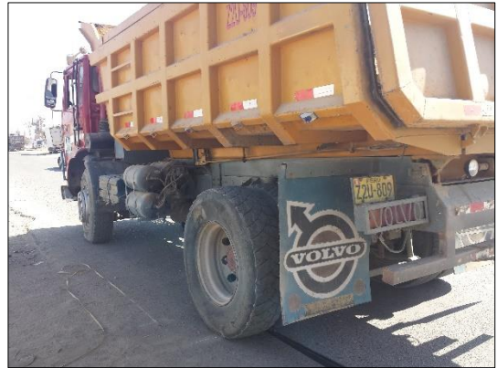
Fotografías 23: Equipo de viga Benkelman (doble brazo) y volquete con un peso aproximado de 8200 kg
