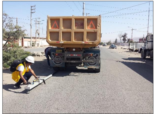
Fotografías 24: Marcando los puntos y posicionamiento de la viga de Benkelman.
