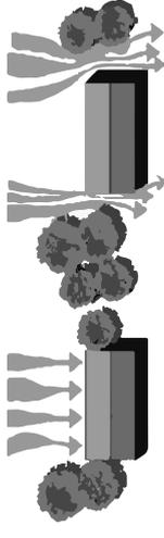
Según la velocidad y trayectoria de los vientos en la zona se dispondrán los bloques para controlar el flujo del viento y recorrido interno acondicionándolo a las necesidades del proyecto.
