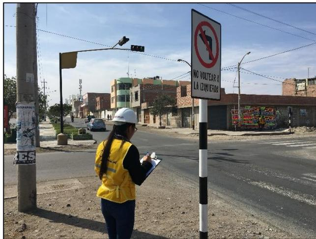
Imagen 2: Se observa la anotación de tiempos de rojo, ámbar y verde de los semáforos de la Intersección I.
