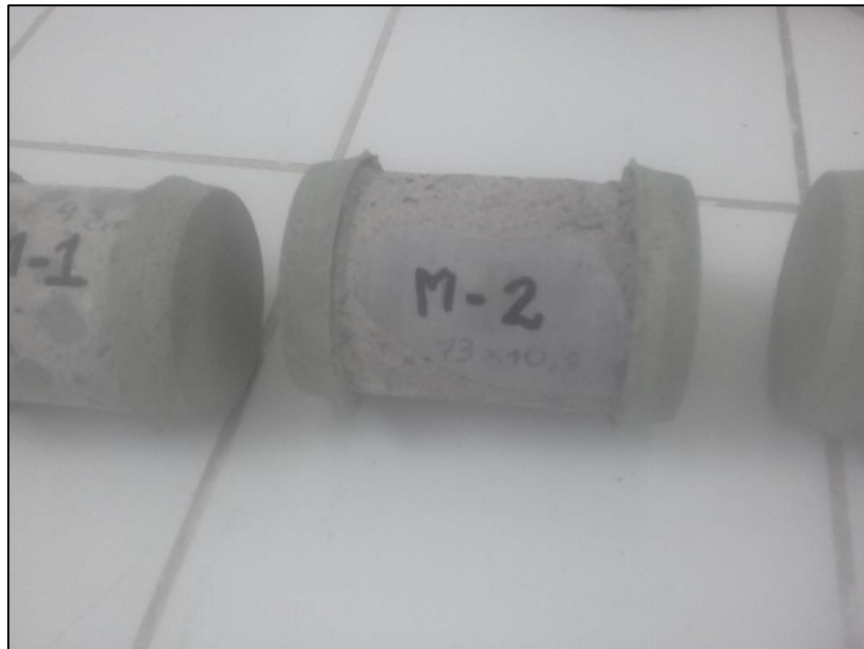
VISTA DE LOS TESTIGOS PREPARADOS PARA LA PRUEBA DE RESISTENCIA A LA COMPRESION.
