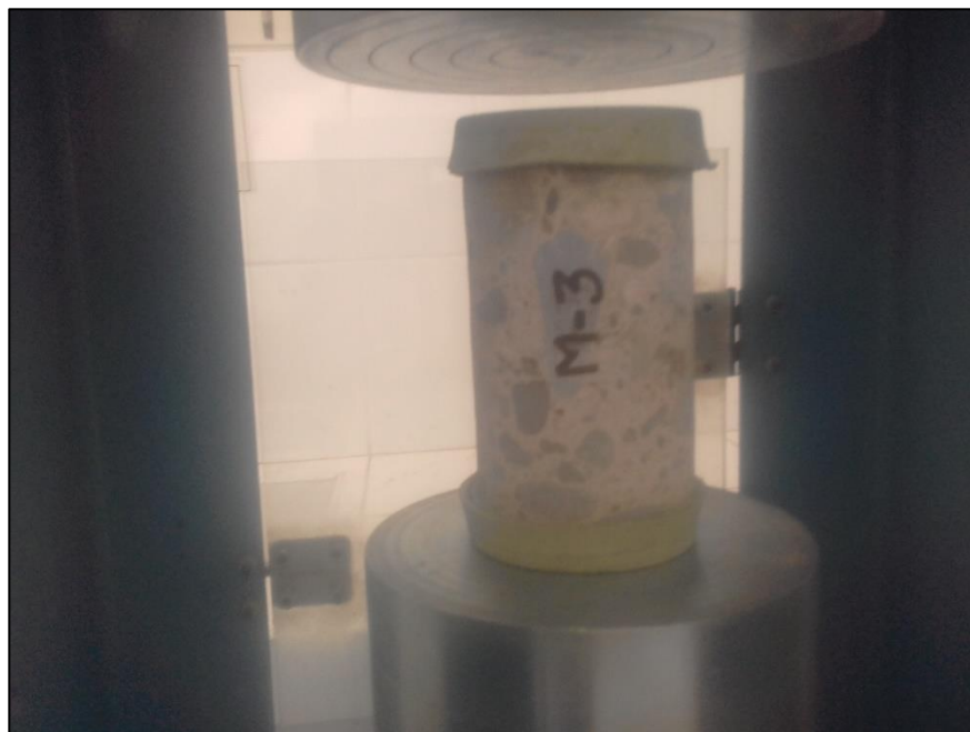
VISTA DEL TESTIGO EN LA PRENSA HIDRAULICA PARA LA PRUEBA A LA COMPRESION
