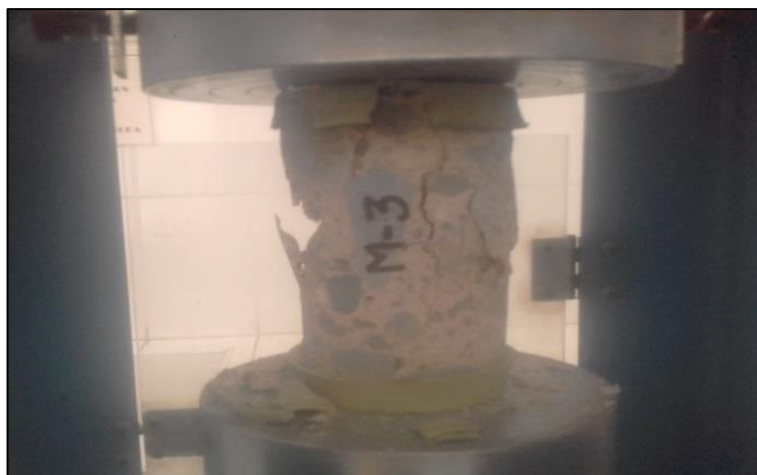
Fig. 4.8 Muestra ensayada con el Equipo de Compresión.
