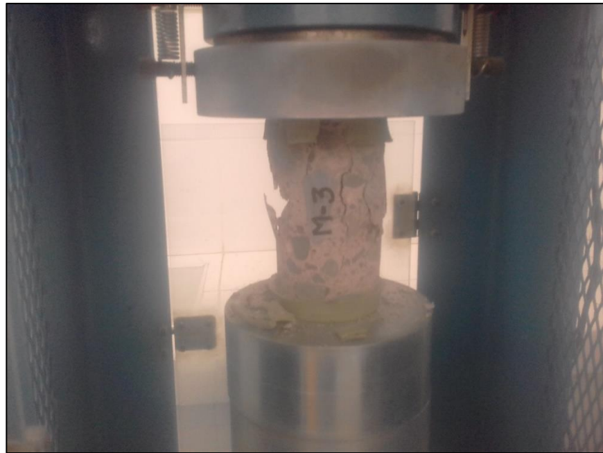
VISTA DE PRUEBA DE RESISTENCIA A LA COMPRESION
