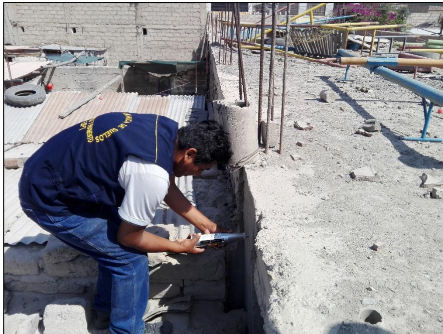
VISTA DE ENSAYO CON ESCLEROMETRO
