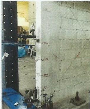
Foto 27. Grietas a flexión en las columnas para una distorsión 1/1100
