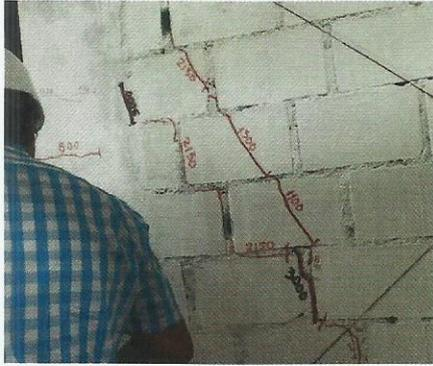
Foto 19. Aparición de más grietas diagonales en el muro para la distorsión 1/400.
