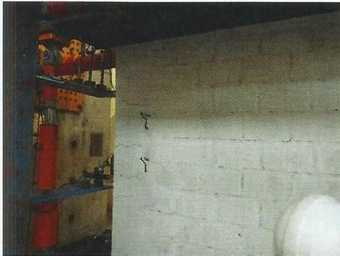
Foto 1. Formación de pequeñas grietas cercanas a las columna Oeste a una distorsión 1/1500.
