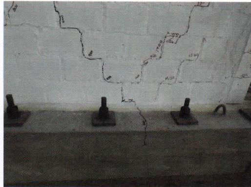
Foto 114. Aparición de grieta en la base de la cara Sur para una distorsión 1/550.
