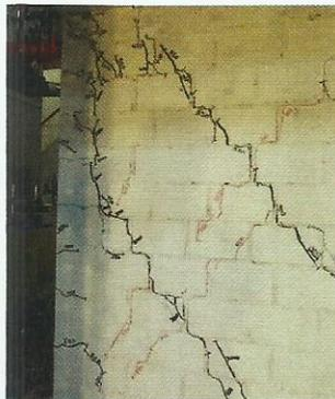
Foto 21. Acumulación de grieta en la diagonal del muro para una distorsión de 1/300.
