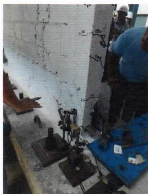
Foto 66. Formación de grietas diagonales en la parte inferior Este de la cara Sur para una distorsión de 1/400.
