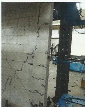
Foto 15. Grietas diagonales en el muro y grietas por flexión en las columnas para una distorsión 1/1100
