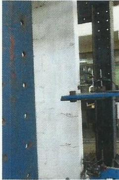
Foto 25. Formación de pequeñas grietas diagonales para una distorsión 1/2150.
