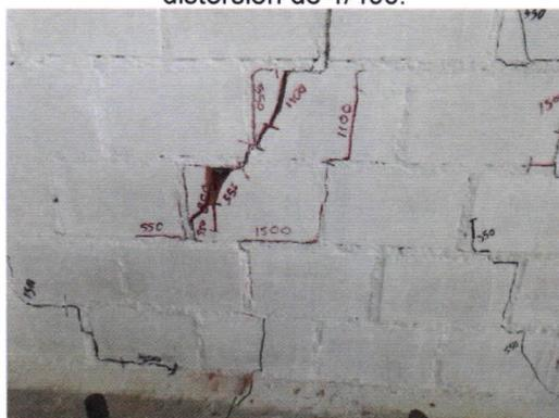
Foto 70. Desprendimiento de ladrillo en la zona central inferior de la cara Sur para una distorsión de 1/400 en el 2º ciclo.
