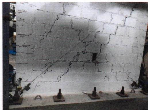
Foto 18. Desprendimiento de la parte izquierda del ladrillo mencionado en la foto anterior para una distorsión de 1/300.
