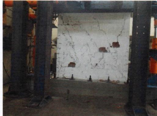
Foto 91. Desprendimiento de ladrillos en la parte superior Este e inferior Oeste de la cara Sur para una distorsión de 1/200.
