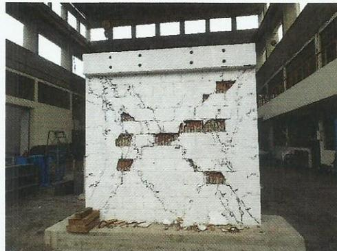
Foto 12. Estado final del muro para una distorsión 1/200.
