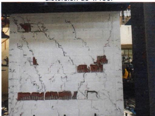
Foto 100. Desprendimiento de ladrillo en la parte superior Oeste de la cara Sur para una distorsión de 1/150.
