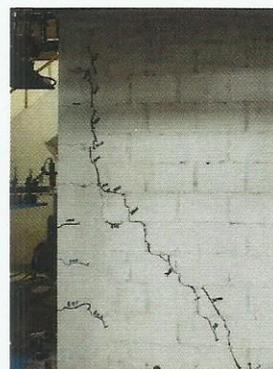
Foto 16. Mas grietas en la diagonal del muro para una distorsión 1/800.
