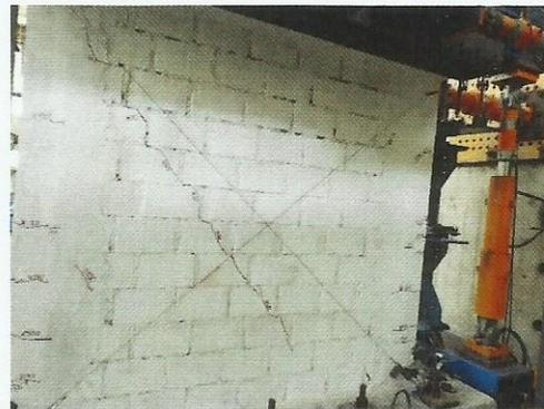
Foto 28. Grietas en la diagonal del muro para una distorsión 1/800.
