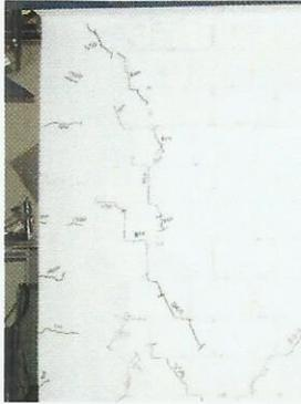
Foto 31. Aparición de más grietas en las columnas para la distorsión 1/550.
