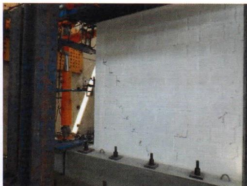
Foto 37. Formación de grietas diagonales en el mortero hasta antes de la parte central en la parte superior e inferior Oeste de la cara Sur para una distorsión 1/1500.
