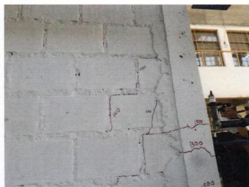
Foto 106. Continuación de grietas en el mortero y en las columnas de la cara Norte y Sur para una distorsión 1/1100.
