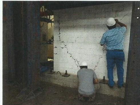
Foto 14. Grietas formadas a largo de la diagonal en la cara sur del muro a una distorsión 1/1100.
