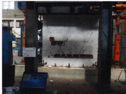
Foto 99. Desprendimiento de ladrillos en la parte inferior central y Este de la cara Norte para una distorsión de 1/150.
