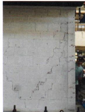
Foto 110. Continuación de grietas en el ladrillo y en el mortero en las caras Norte y Sur para una distorsión de 1/800.
