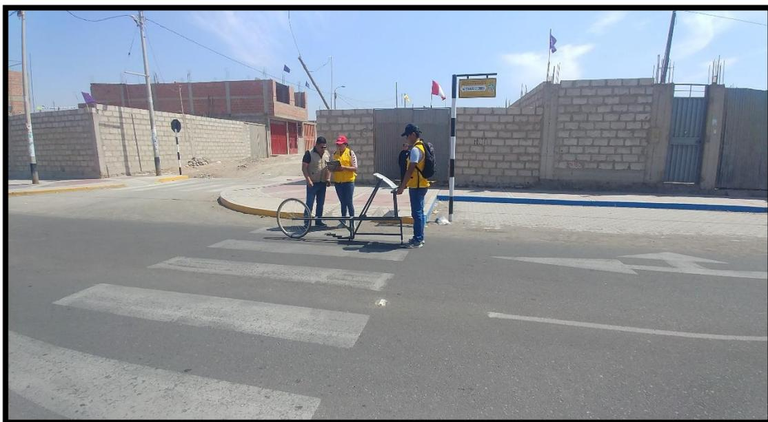
EJECUCIÓN DEL ENSAYO DEL RUGOSÍMETRO DE MERLÍN
