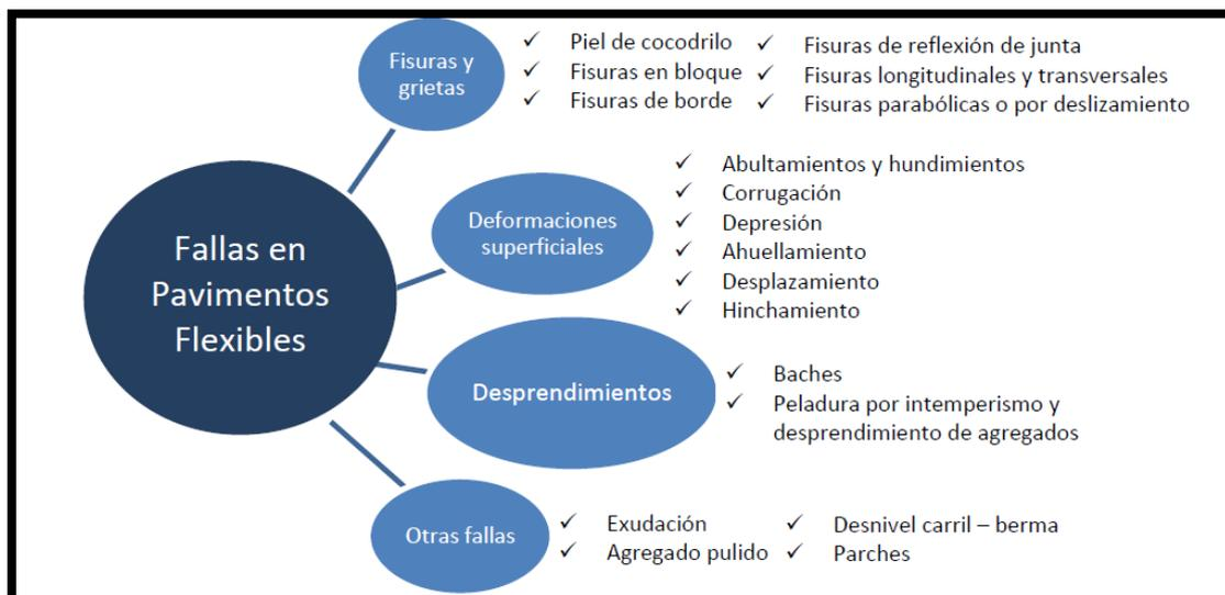
Figura 10: Resumen de fallas en pavimentos flexibles
