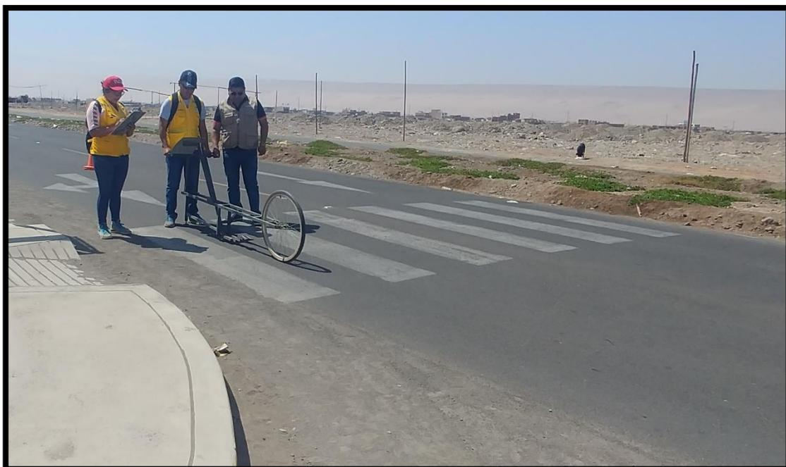
EJECUCIÓN DEL ENSAYO DEL RUGOSÍMETRO DE MERLÍN
