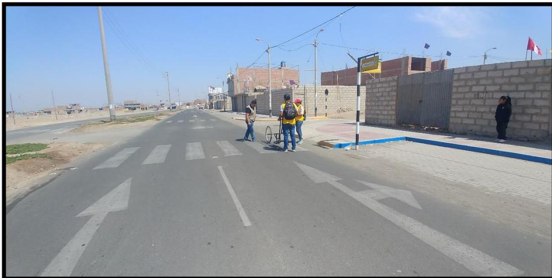
EJECUCIÓN DEL ENSAYO DEL RUGOSÍMETRO DE MERLÍN
